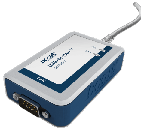
Figura 33. USB-to-CAN de IXXAT utilizado para configurar el controlador SEVCON. [23]
