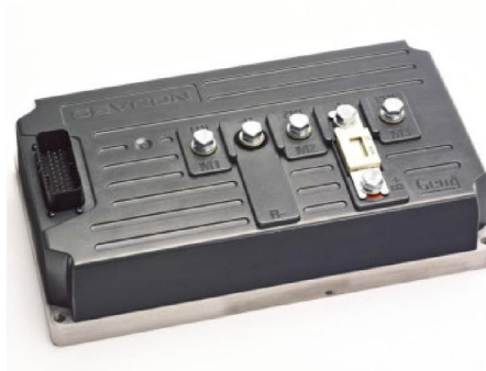
Figura 22. Controlador SEVCON Gen4 Size 6 usado en el proyecto. [19]
