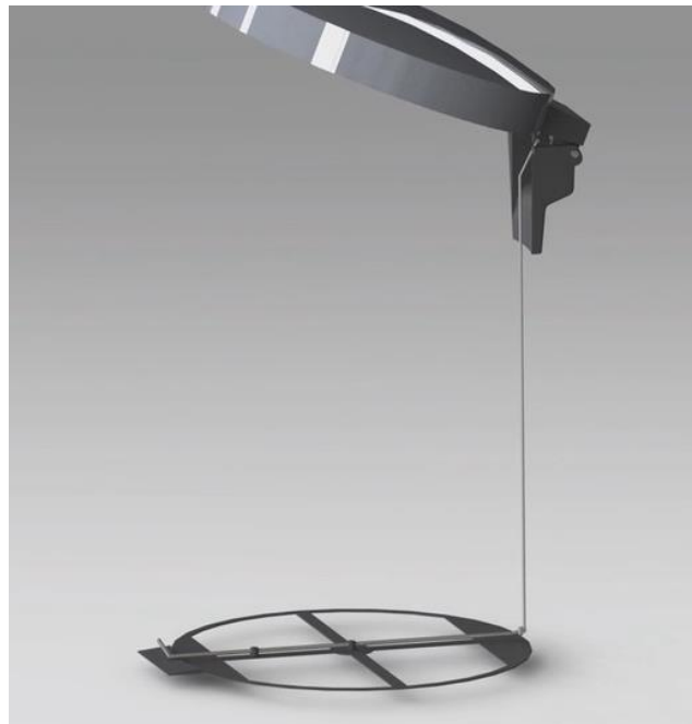
Ilustración 11: Mecanismo de apertura mediante sistema de varillas (Alexandre Soares, grabcad.com/library/pedal-trash-can-1 )
