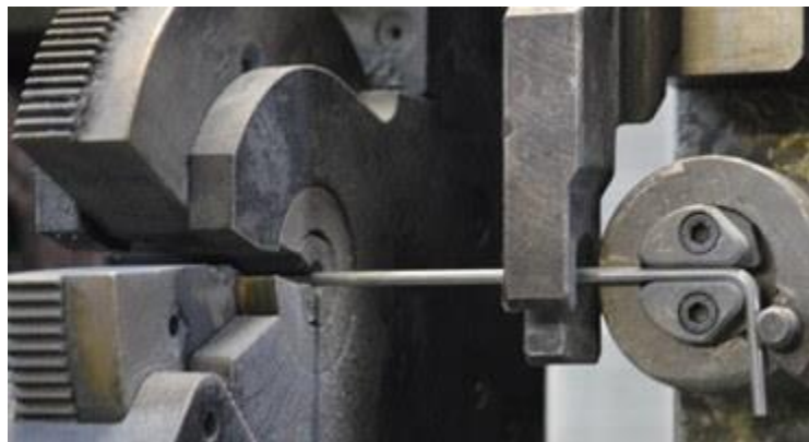
Ilustración 63: Proceso de conformado de alambre (cvcspring.com/es/conformado-de-alambre/)
