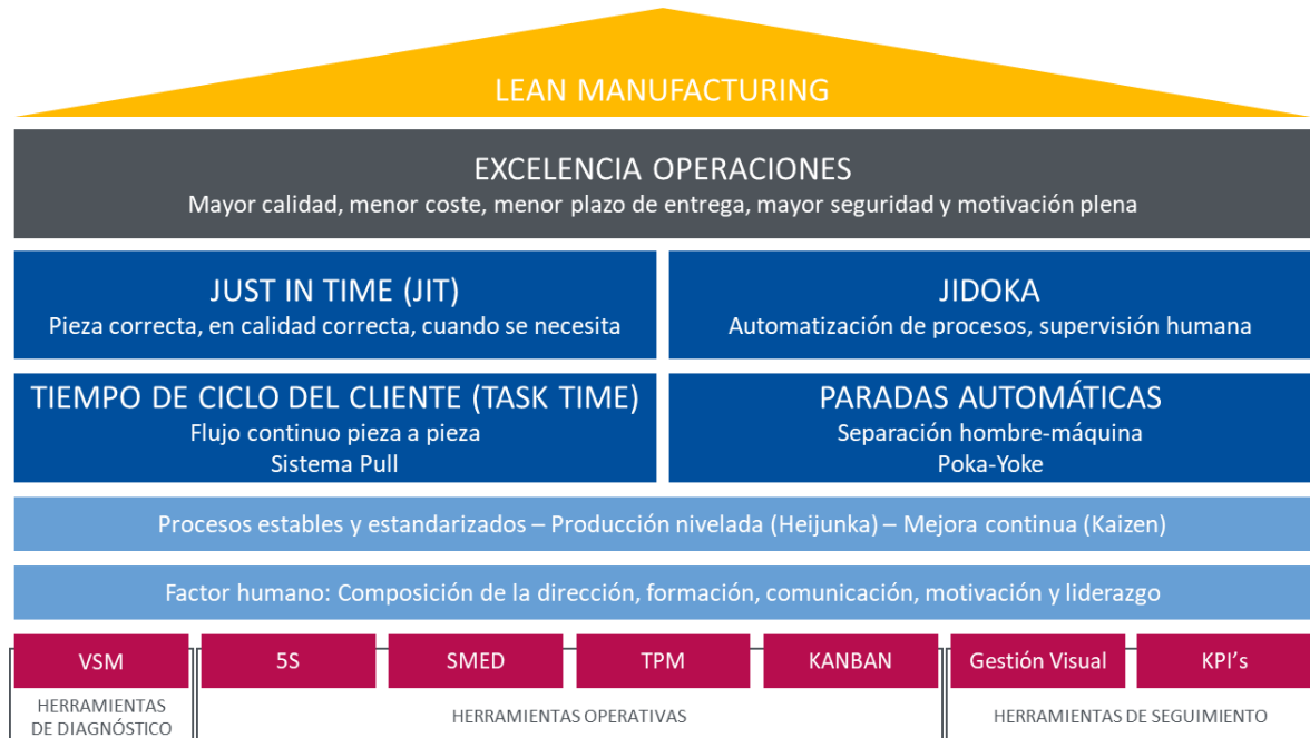
Ilustración 21: Estructura del Lean Manufacturing
