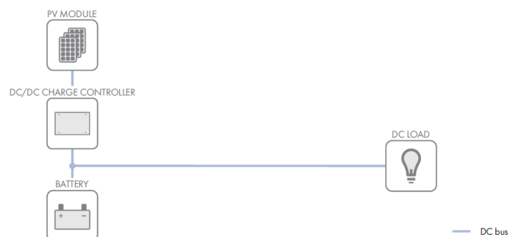
Figura 3.9. Ejemplo de un sistema con acoplamiento en CC.
