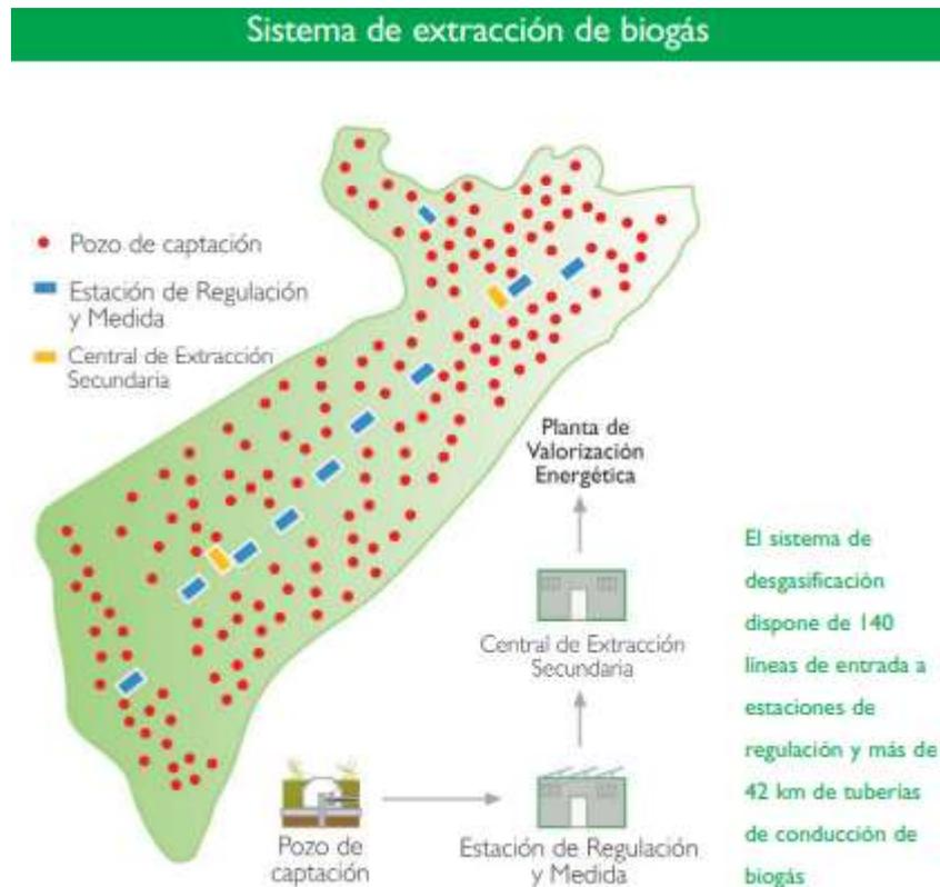
Figura 42. Sistema de extracción de biogás en el Centro de Tratamiento La Galiana [63]
