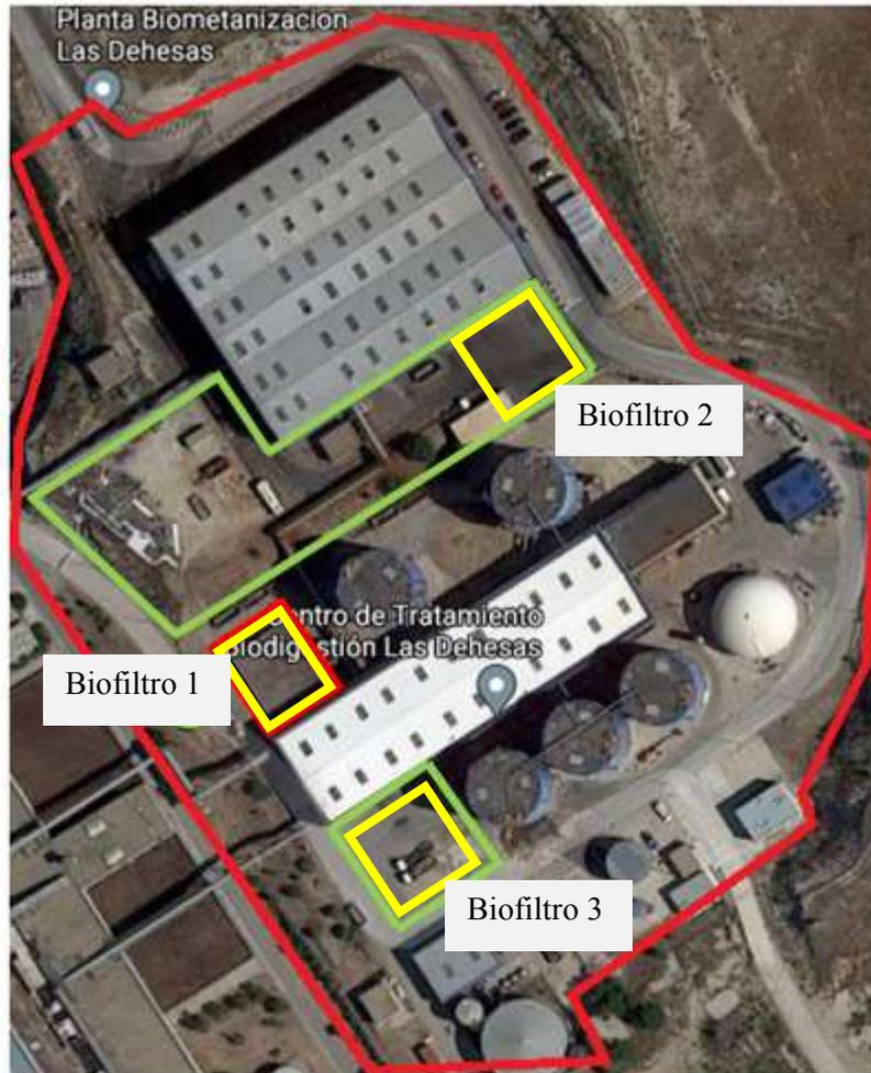
Figura 65. Emplazamiento de los biofiltros. Propuesta 2 [6] [75]
