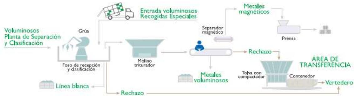
Figura 37. Proceso seguido en el Área de Tratamiento de residuos voluminosos del Centro de Tratamiento de Las Dehesas [63]
