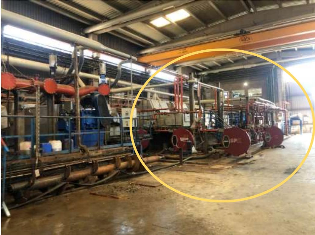
*Figura 53. Centrifugas para la deshidratación del digesto en la Planta de Biometanización de Las Dehesas [58]*
