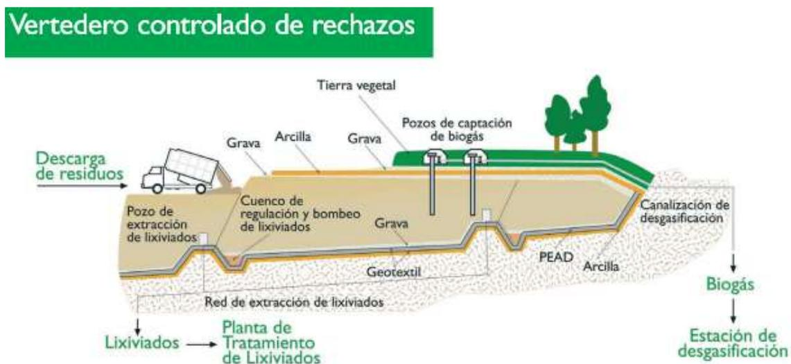
Figura 41. Esquema del vertedero del Centro de Tratamiento de Las Dehesas [63]
