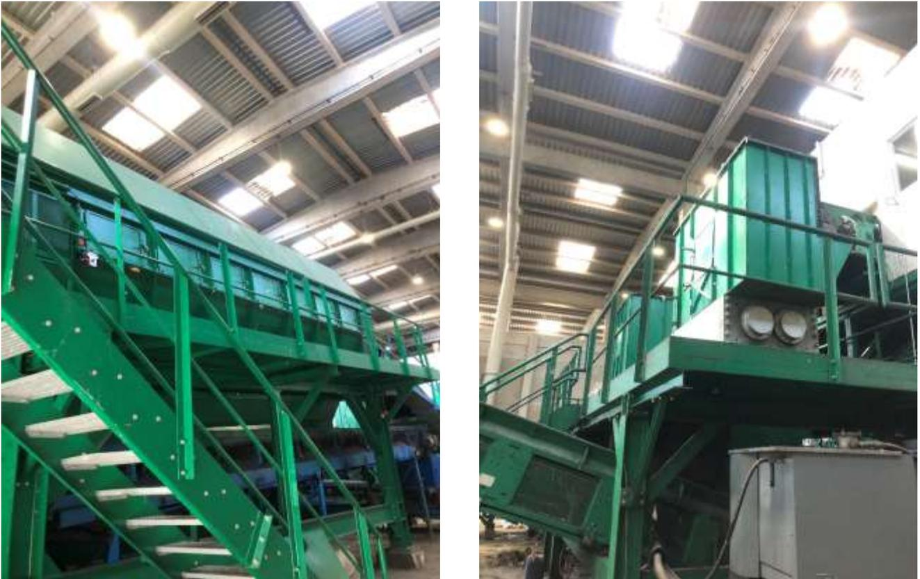
*Figura 49. Trómeles para la separación de residuos voluminosos y otras impurezas de la materia orgánica [58]*
