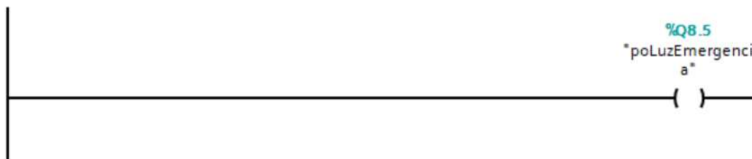
Figura 6: Encendido de la luz de emergencia (2)
