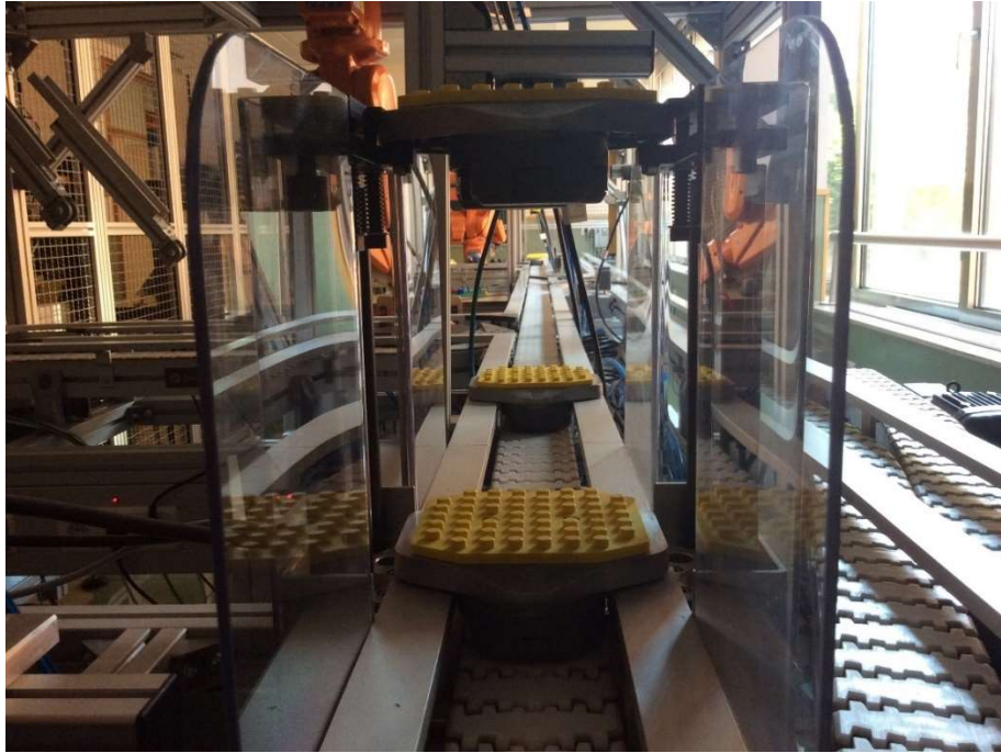
Figura 8: Imagen del posicionador túnel
