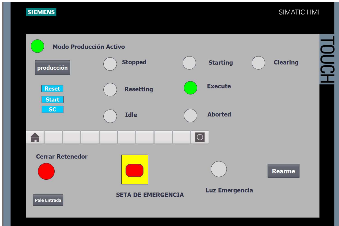
Figura 2: Posible HMI para controlar el sistema
