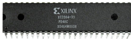
Figura 1.3: Xilinx XC2064: Primer modelo FPGA comercial
