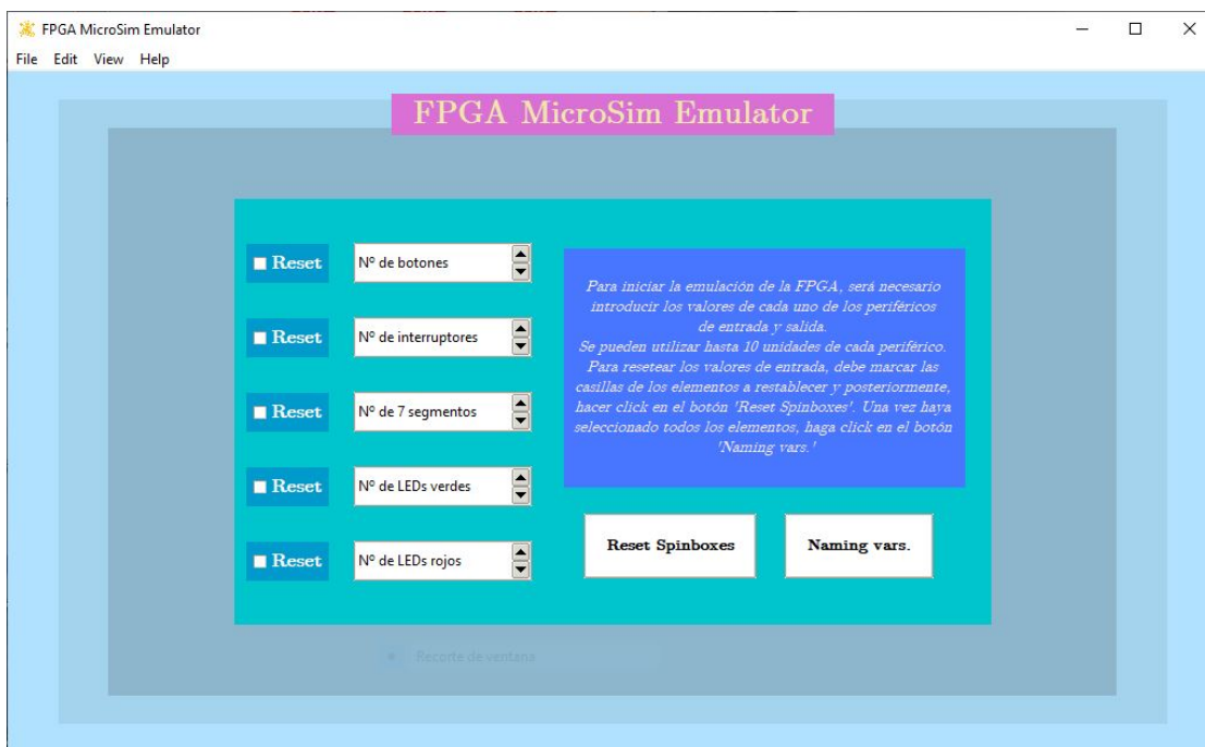
Figura 5.5: Ventana de elección - Entradas y salidas - FPGA Emulator
