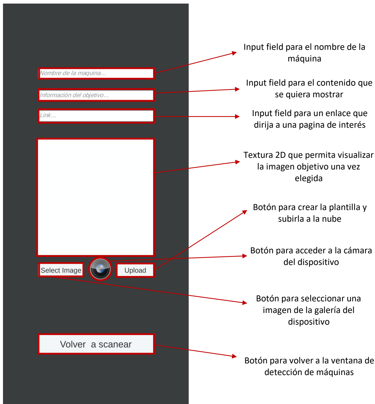
Figura 11 - Ventana de creación de plantillas para máquinas
