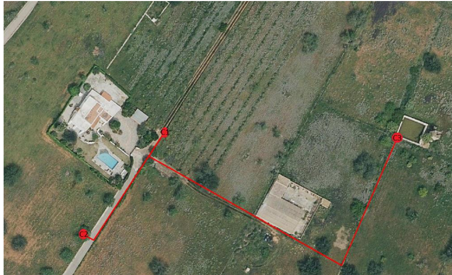
Ilustración 14. Disposición de las cajas de conexión y cableado "verde". Fuente: elaboración propia.
