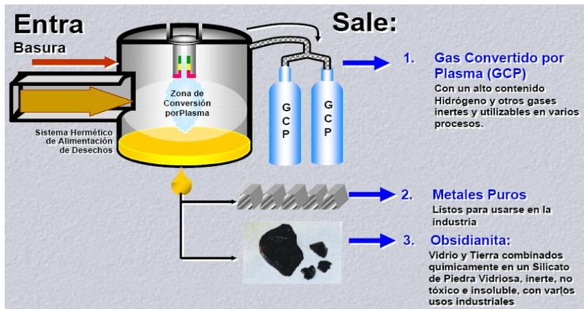
Figura 16: Proceso de gasificación por plasma (Fuente: Julio Montes, 2006)
