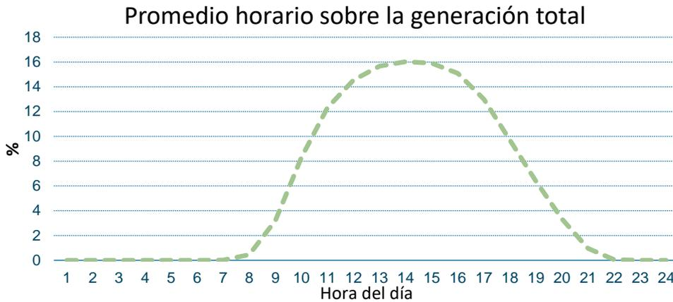
Figura 12: Perfil medio horario de la solar fotovoltaica sobre la generación total en 2020 (%). (Fuente: REE)
