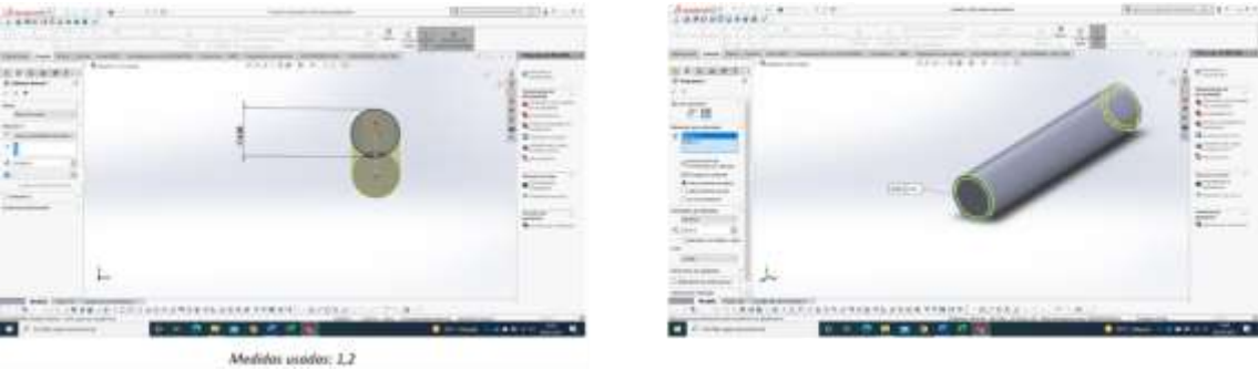
Figura 198: Proceso de diseño del pasador corto de la pieza agujereada
