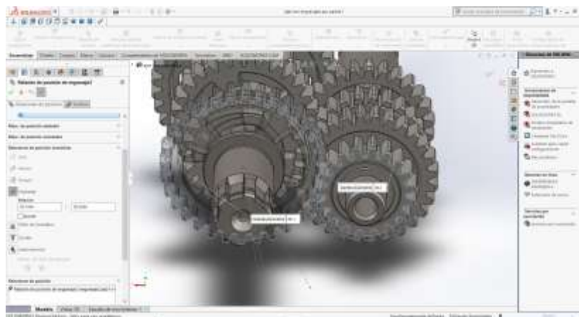
Figura 275: Relación de engrane entre los engranajes 5 de cada eje
