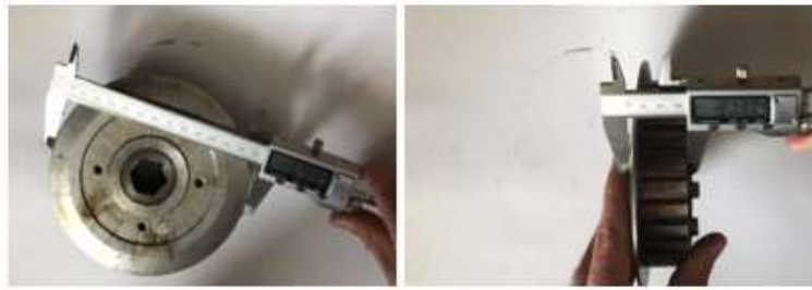
Figura 4: Toma de medidas con un calibre pie de rey
