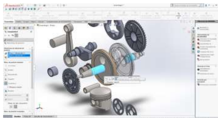
Figura 247: Condición ejes de manivelas concéntricos
