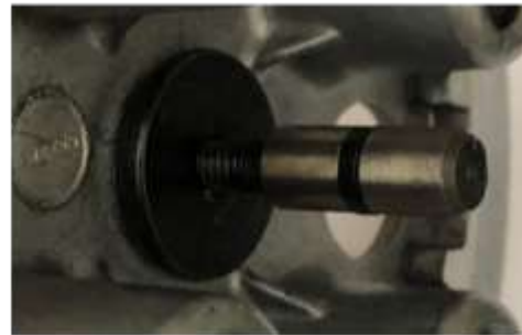
Figura 112: Comparación del empujador del plato de presión
