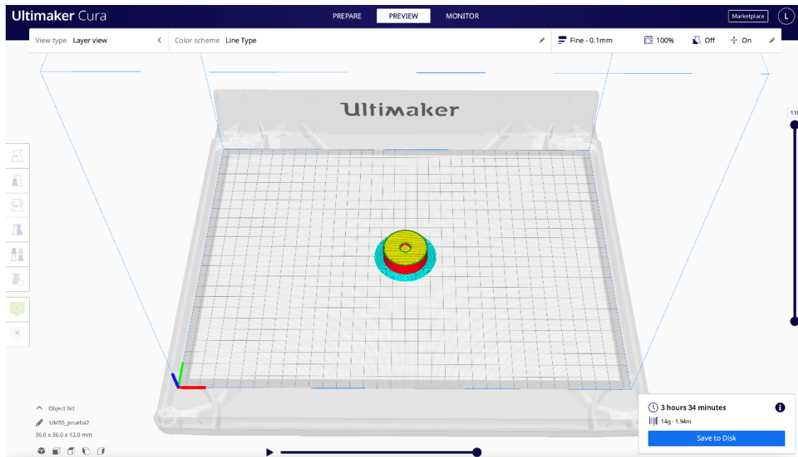
Ilustración 21 - Imagen del software Ultimaker Cura con el resonador de filamento ABS
