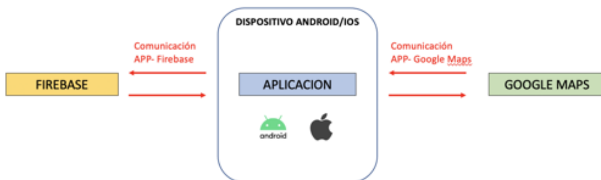
Figura 3.19: arquitectura de las comunicaciones entre la app y los distintas tecnologías
