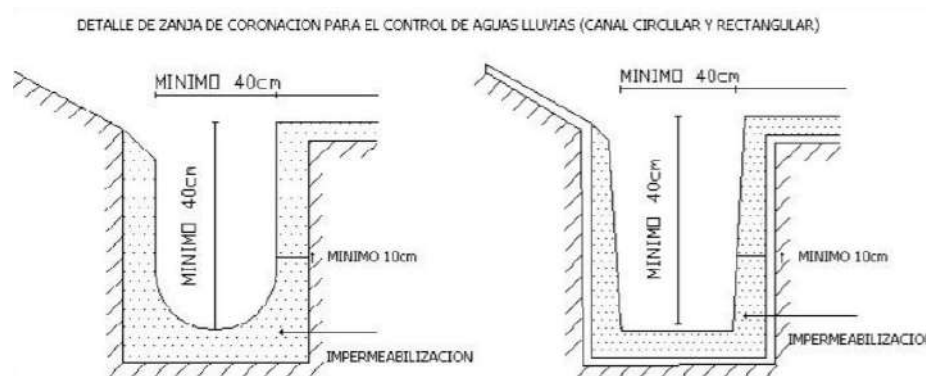
Figura 5.23: Trincheras perimetrales para la evacuación del agua de lluvia [UIS_05]
