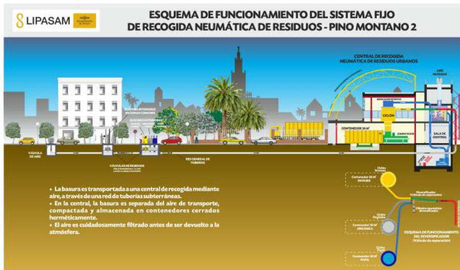
Figura 3.12: Sistema neumático fijo de recogida de RSU [LIP_20]
