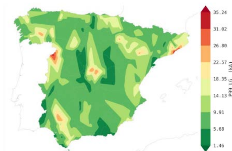
Figura 101. Mapa de curvas de nivel con la distribución de los valores medios de intensidad de cortocircuito monofásico en los nudos de 220 kV. [75]
