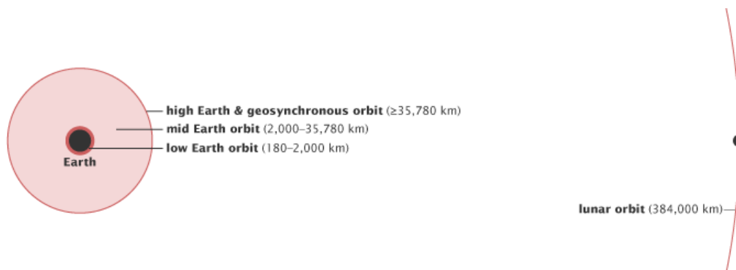
Figura 5. Principales tipos de órbita según altitud [19]
