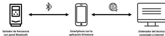
Ilustración 1: Esquema de conexiones de Mobile Connect
