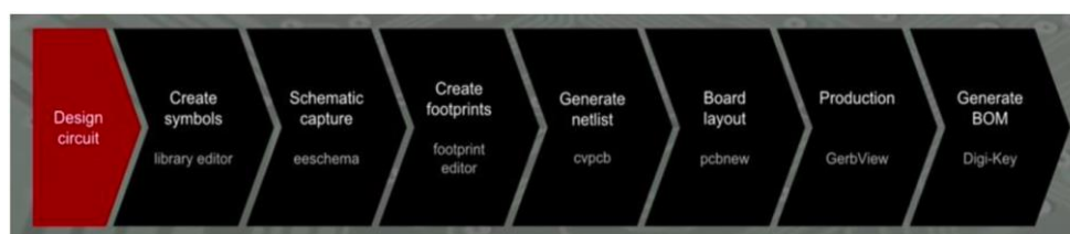
Figura 23: Proceso seguido para desarrollar la placa [30]
