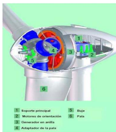
Figura 27 - Esquema interior aerogenerador sin caja multiplicadora [ALON21]
