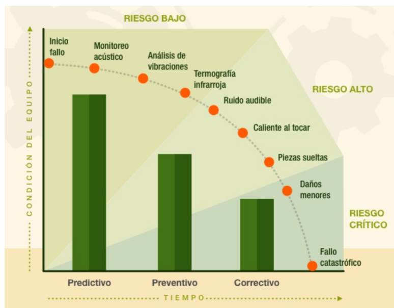
Figura 18: Gráfica tiempo-condición de un aerogenerador
