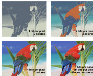
Figura 4.2: Diferencias de color en función del número de bits por píxel
