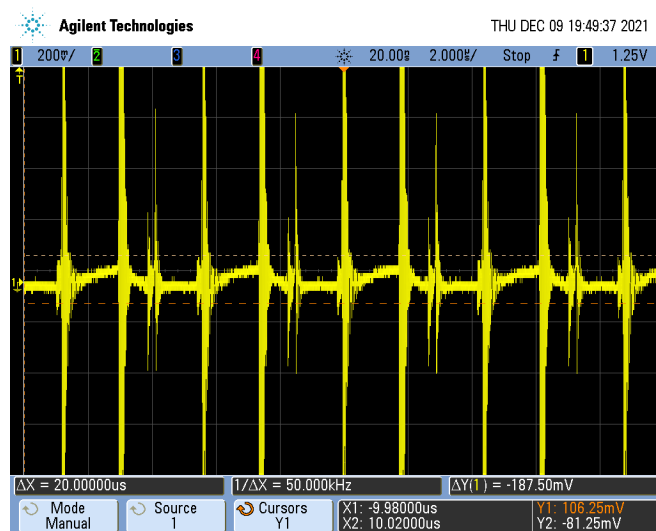
Figura 37. V_{out} del elevador a 12V
