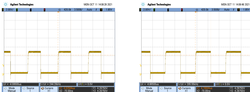
Figura 25. Diferentes Ciclos de Trabajo según la tensión de entrada
