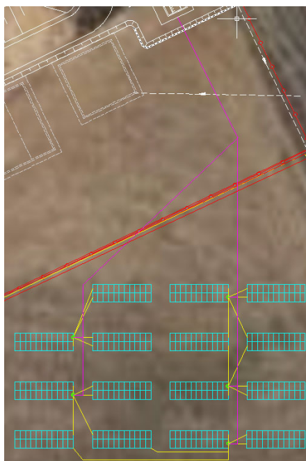
Figura 36. Tramo de cableado CA (rosa).
