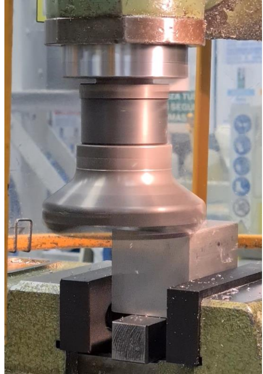
ILUSTRACIÓN 95: ENSAYO PROTOTIPO 1 DE GARRA PARA MORDAZA (2)
