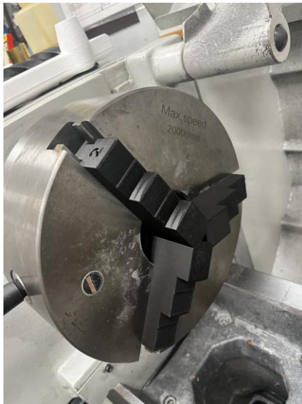
ILUSTRACIÓN 106: DETALLE DEL ENCAJE LAS TRES GARRAS IMPRESAS
