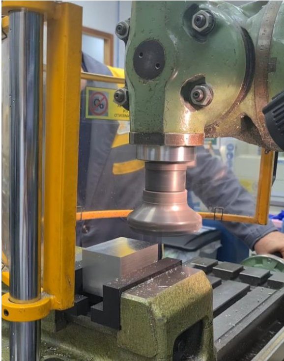
ILUSTRACIÓN 100: ENSAYO PROTOTIPO 2 DE GARRA PARA MORDAZA (1)
