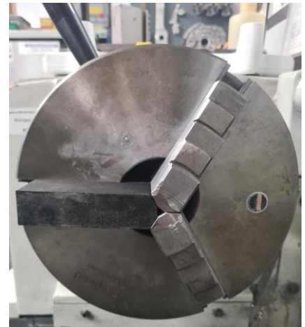
ILUSTRACIÓN 67: COMPROBACIÓN DE QUE LAS GARRAS ENCAJAN ENTRE SÍ
