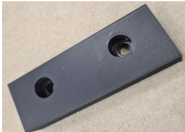
ILUSTRACIÓN 61: RESULTADO DE IMPRESIÓN DE GARRA PARA MORDAZA
