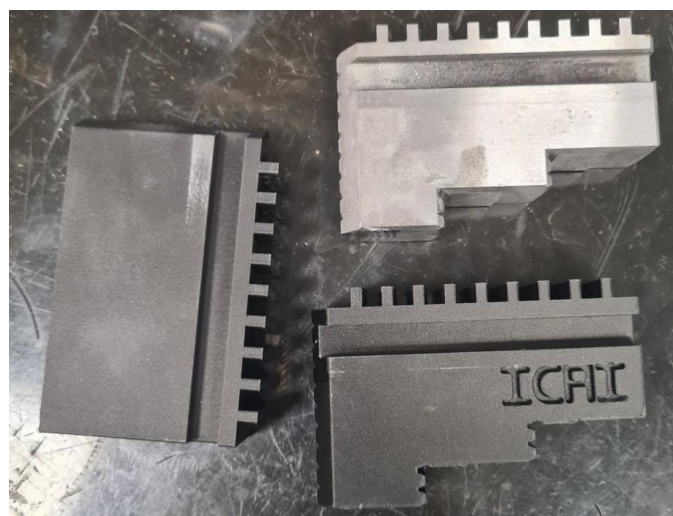
ILUSTRACIÓN 2: GARRA PARA TORNO ORIGINAL (ARRIBA DERECHA) Y DOS PROTOTIPOS IMPRESOS POR ADITIVA
