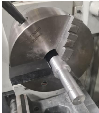
ILUSTRACIÓN 66: GARRA PARA TORNO SUJETANDO UNA PIEZA
