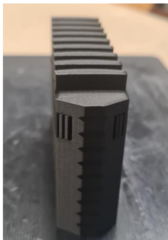
ILUSTRACIÓN 63: RESULTADO IMPRESIÓN GARRA PARA TORNO
