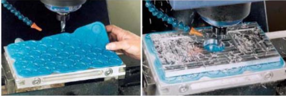
ILUSTRACIÓN 33: EJEMPLO DE SUJECIÓN POR VACÍO
