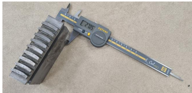
ILUSTRACIÓN 38: PIE DE REY MIDIENDO GARRA DE TORNO
