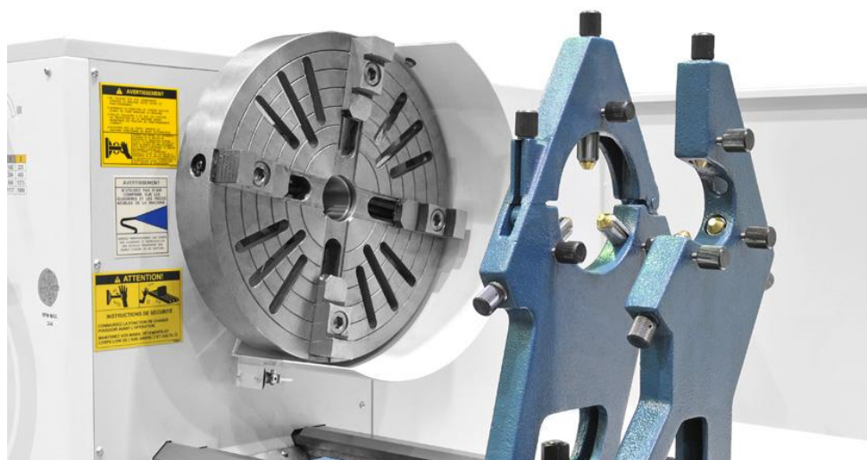
ILUSTRACIÓN 18: EJEMPLO DE UTILLAJES; PLATO Y LUNETAS
