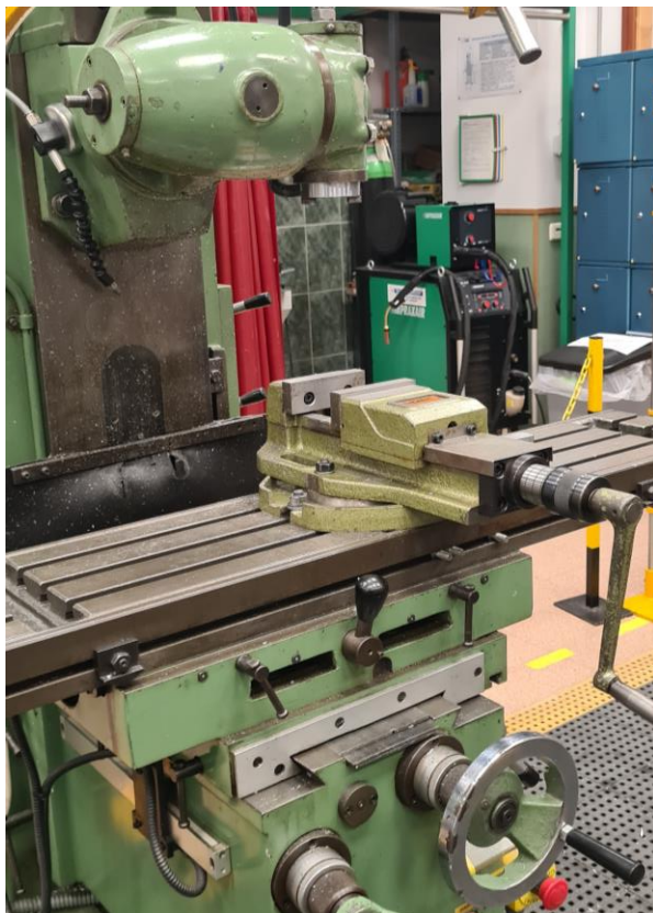
ILUSTRACIÓN 47: FRESADORA Y MORDAZA EMPLEADA
