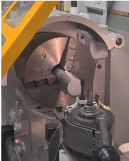
ILUSTRACIÓN 103: COMPROBACIÓN APRIETE DE PIEZA EN EL PLATO DE GARRAS
