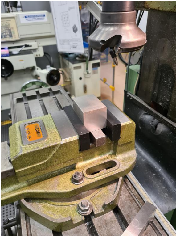
ILUSTRACIÓN 96: ENSAYO PROTOTIPO 1 DE GARRA PARA MORDAZA (1)
