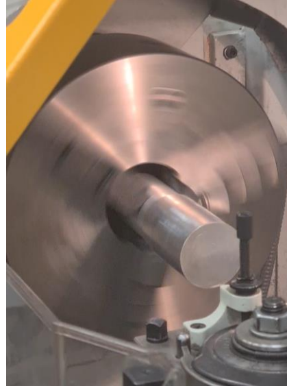
ILUSTRACIÓN 104: DETALLE PIEZA A 400 REVOLUCIONES
