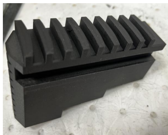
ILUSTRACIÓN 111: ESTADO DE LAS GARRAS TRAS MECANIZADO (2)
