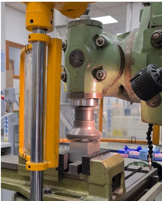
ILUSTRACIÓN 94: ENSAYO PROTOTIPO 1 DE GARRA PARA MORDAZA (3)
