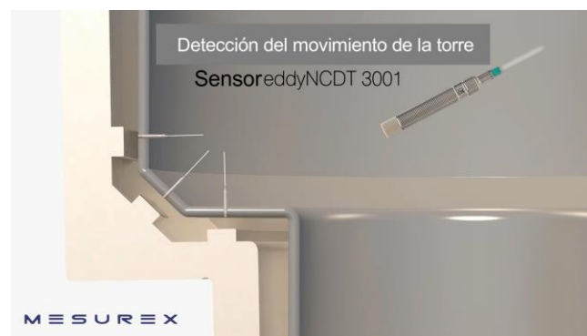
Ilustración 99: Ejemplo de Sensor Eddy NCDR 3001
