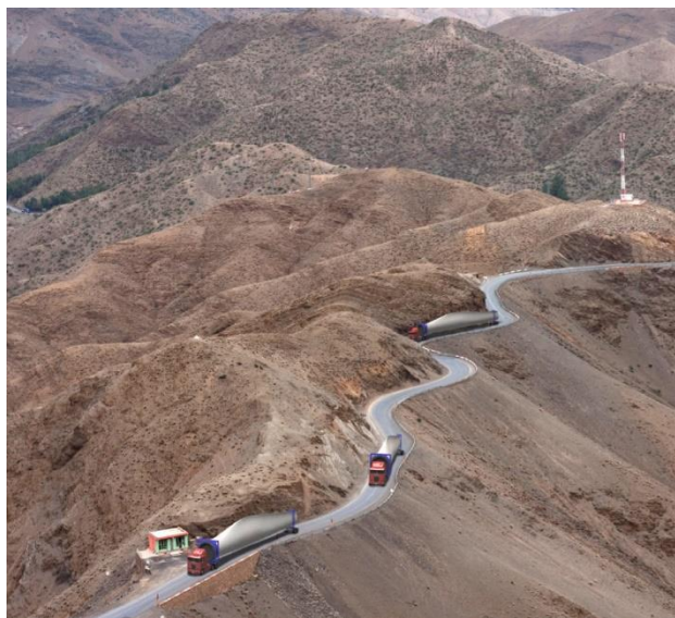
Ilustración 100: Transporte de pala dividida en tres partes
