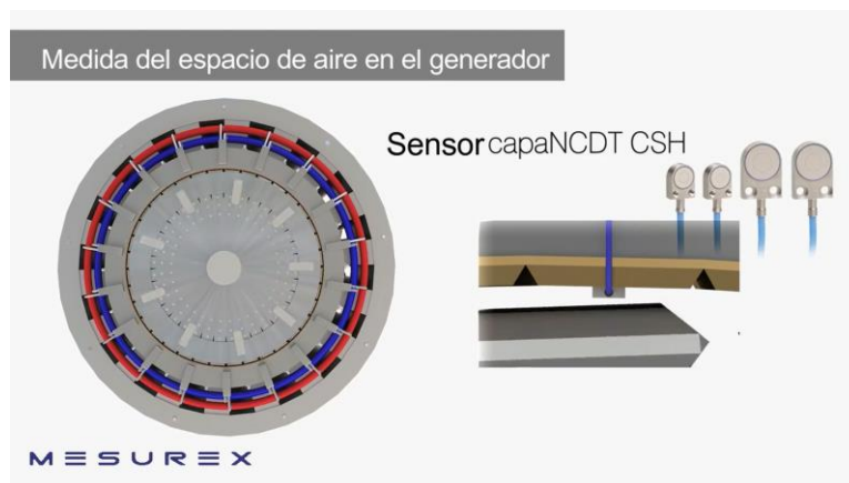
Ilustración 97: Ejemplo de Sensor capaNCDT CS4FL
