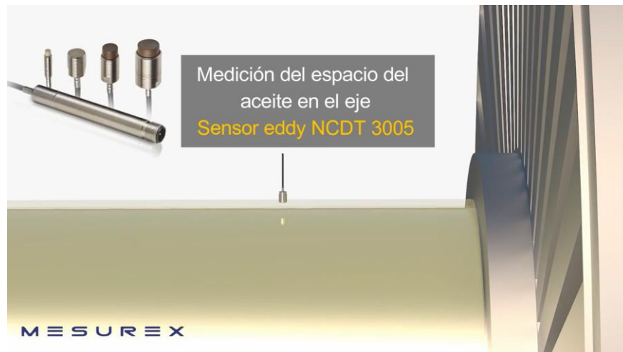
Ilustración 94: Ejemplo de ubicación del Sensor Eddy NCDT 3005
