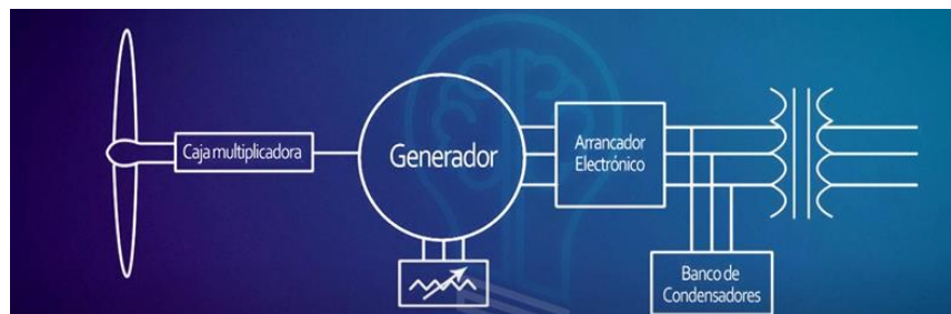
Ilustración 28: Estructura de un aerogenerador tipo 2
