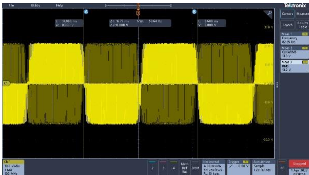
Ilustración 80: Señal de salida, V_{ab} , sin filtrar
