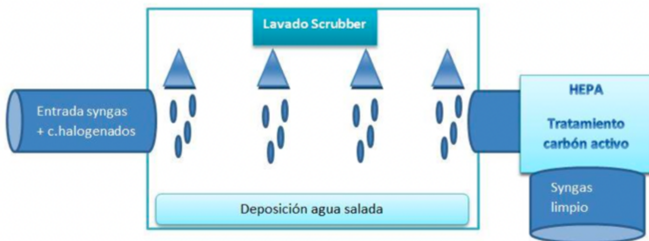
Figura 32: Esquema del sistema de neutralización (Valenciano López, 2015: 54)
