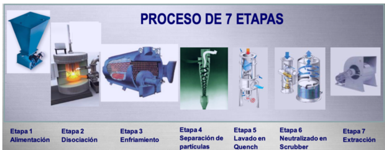
Figura 29: Etapas del proceso de gasificación por plasma, Imagen de: Aventure: 11.
