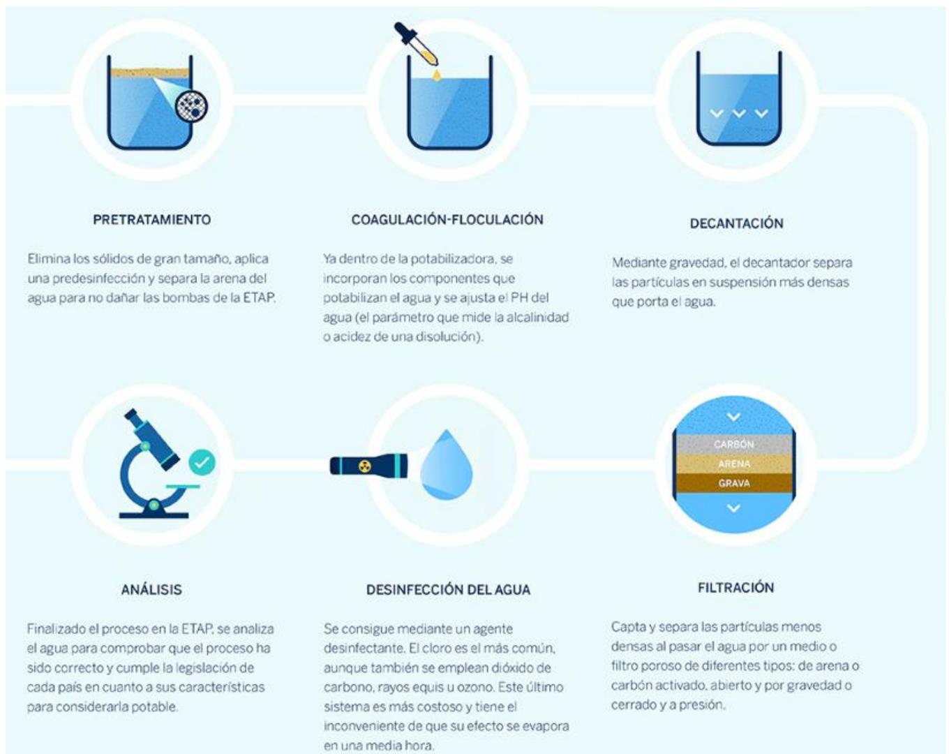
FIGURA 14 FASES DE LA POTABILIZACIÓN DEL AGUA
