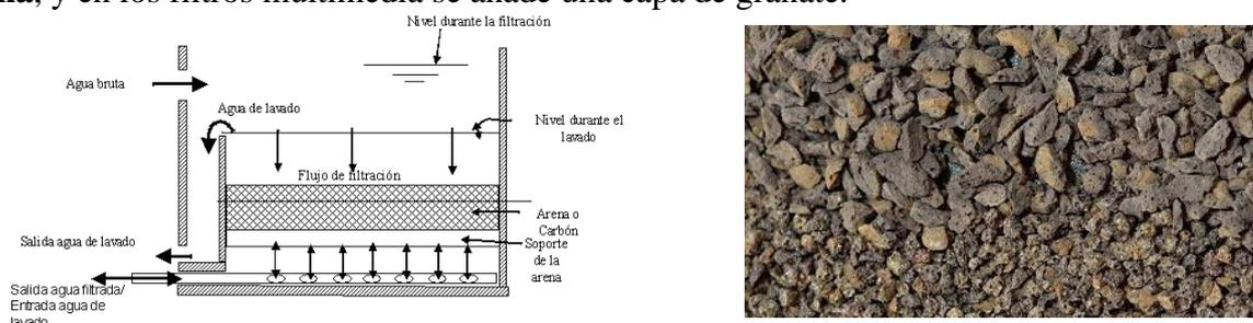
**FIGURA 17 ESQUEMA DE UN FILTRO RÁPIDO POR GRAVEDAD Y FILTRO**
