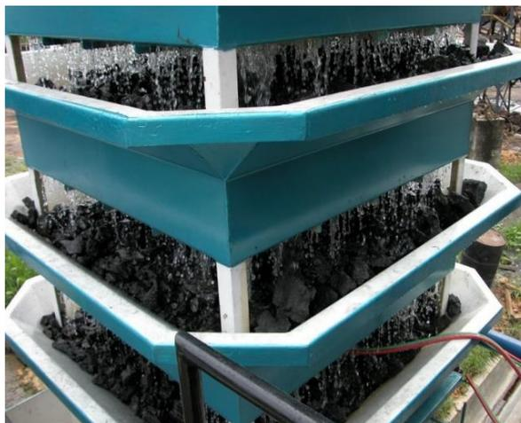
**FIGURA 23 SISTEMA DE AIREACIÓN**
