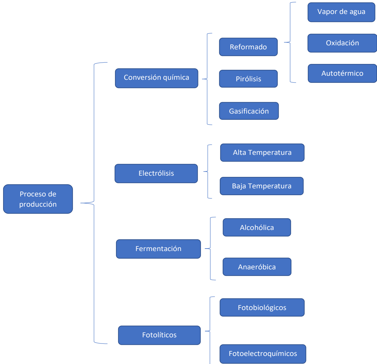
Ilustración 16. Clasificación Procesos de producción H 2 . Elaboración propia según "El Hidrógeno y la Energía"
