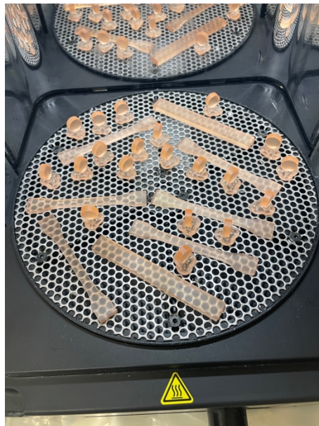
Imagen 17: Probetas de resina después de ser curadas en la FormCure
