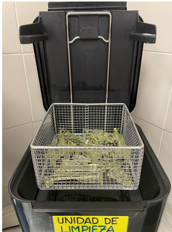
Imagen 16: Probetas de resina en la FormWash
