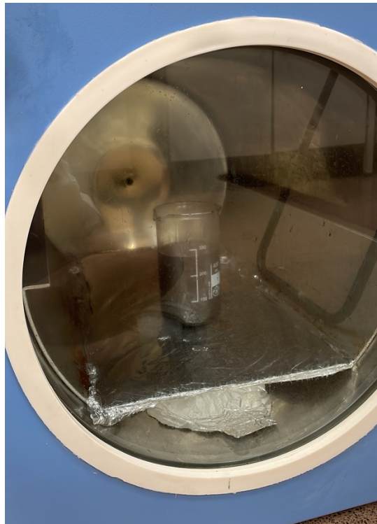
Imagen 19: Mezcla de resina, MMA y GO en la cámara de vacío
