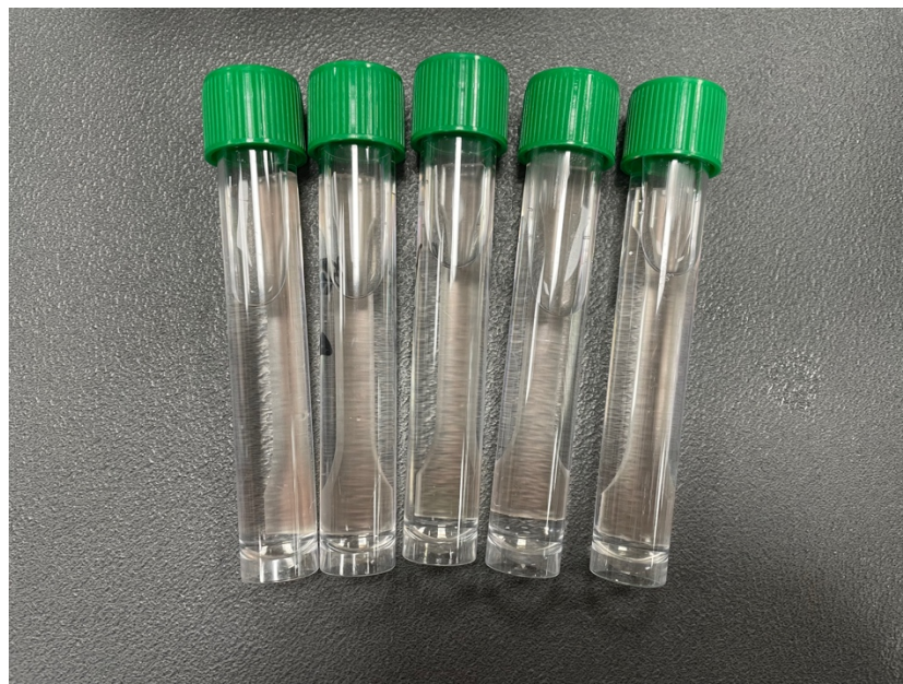
Imagen 23: Probetas de tracción de resina una vez envejecidas
