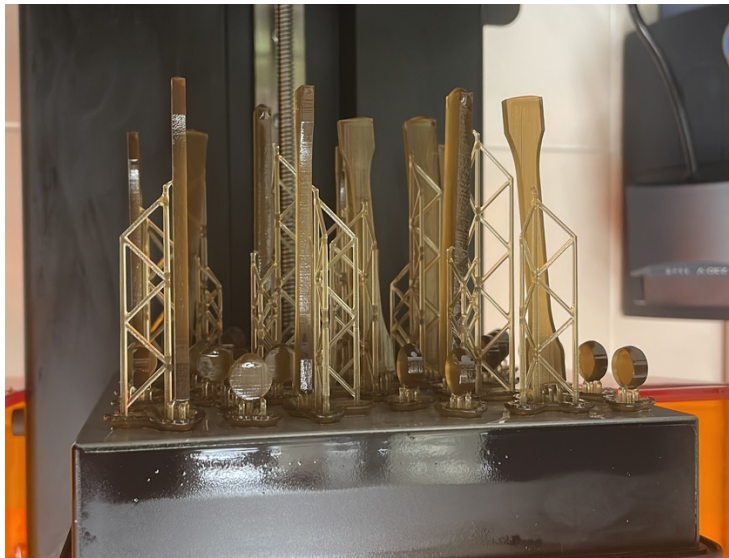
Imagen 20: Probetas de resina, MMA y GO en la plataforma de la impresora
