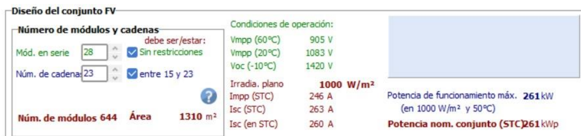
Imagen 25. Características básicas de la instalación fotovoltaica
