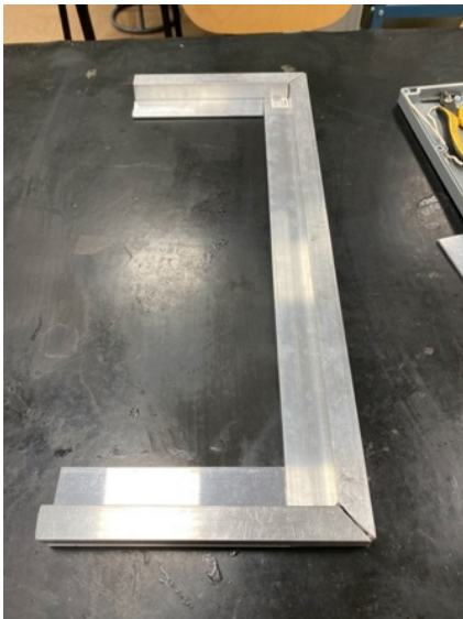
Ilustración 30: Perfilera de aluminio para las puertas.
