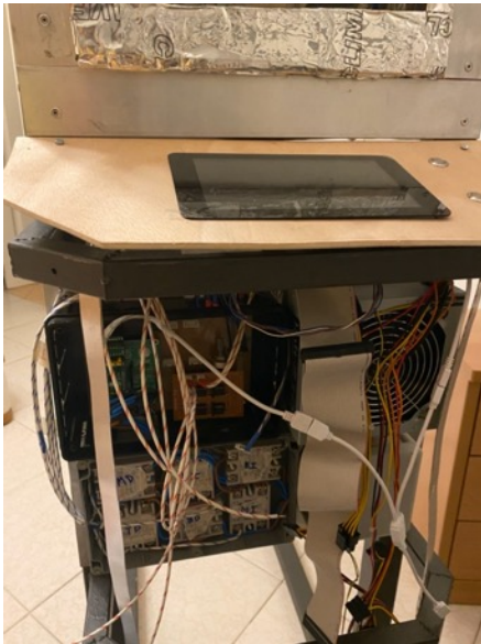
Ilustración 73: Montaje provisional de pantalla táctil y electrónica.
