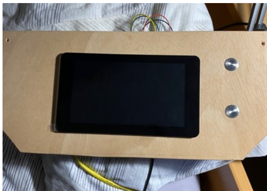
Ilustración 67: Montaje del panel frontal en maqueta con pantalla táctil y botones.
