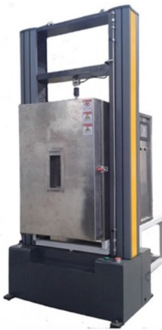
Ilustración 8: Máquina universal de ensayos con cámara térmica.
