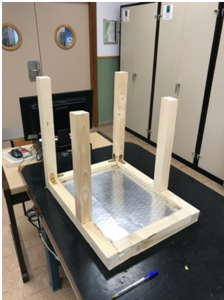
Ilustración 25: Maqueta de la cámara térmica.
