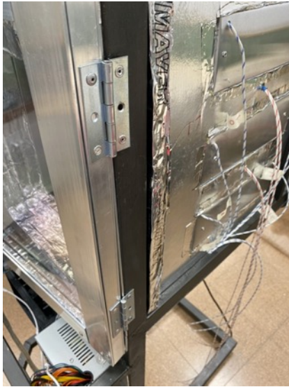
Ilustración 32: Unión de la puerta frontal con bisagras.
