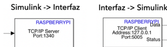
Ilustración 65: Bloques de comunicación desde Simulink.
