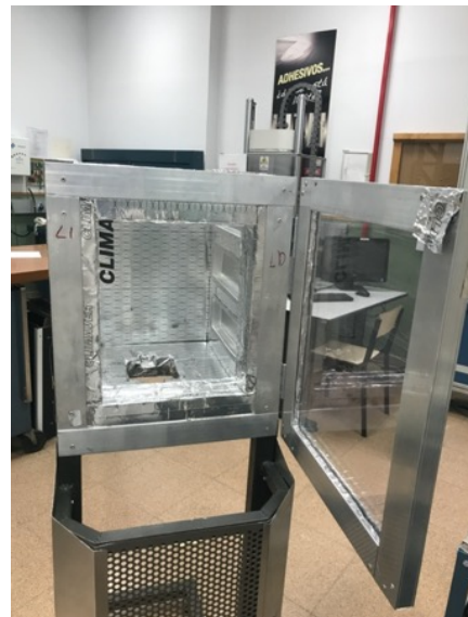
Ilustración 31: Estructura con Climaver y perfilera de aluminio.
