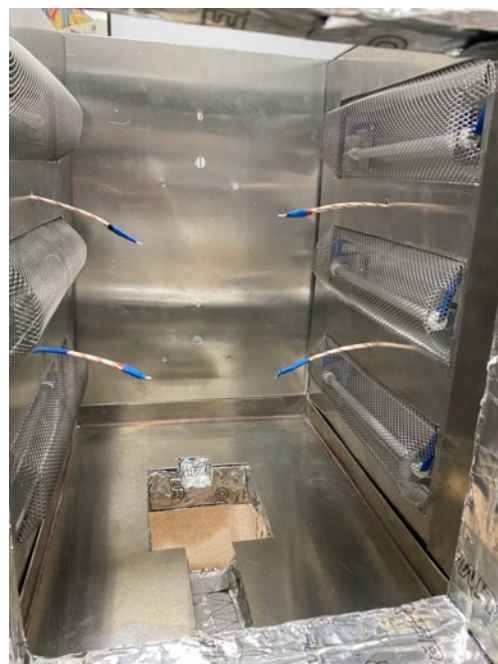
Ilustración 43: Rejillas de protección para los tubos halógenos.
