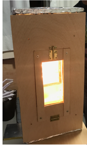
Ilustración 13: Puerta de cristal del prototipo.
