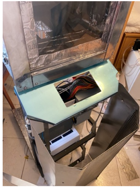
Ilustración 76: Montaje de la electrónica con chapa de aluminio.
