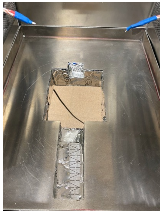
Ilustración 39: Recorte de la base de la cámara para mordaza y vástagos.
