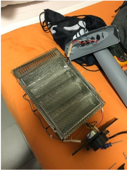
Ilustración 12: Calefactor comercial desmontado.
