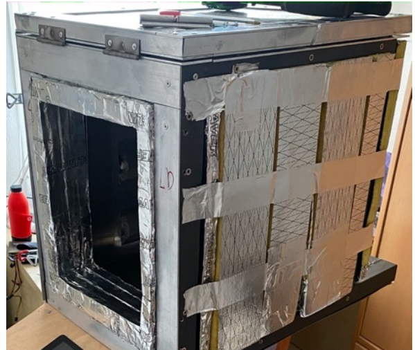
Ilustración 38: Recubrimiento lateral de los tubos halógenos.
