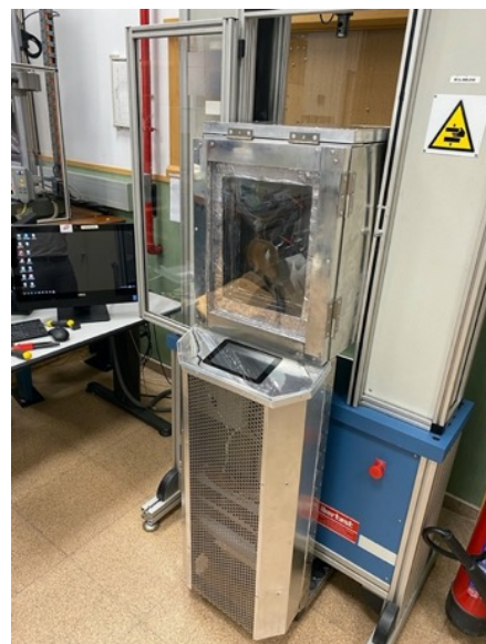
Ilustración 3: Cámara térmica finalizada.
