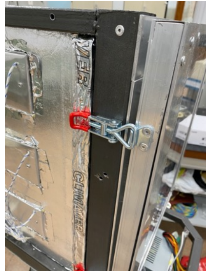
Ilustración 33: Cierre a presión de la puerta frontal.
