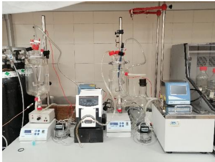
Figura-R 4: Construcción Final Reactor Discontinuo. Fuente: Propia.
