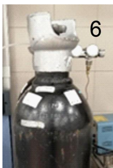
Ilustración 44: Detalle Balas de Nitrógeno
