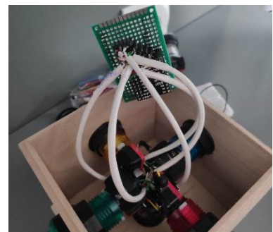
Ilustración 22: Cableado de botones
