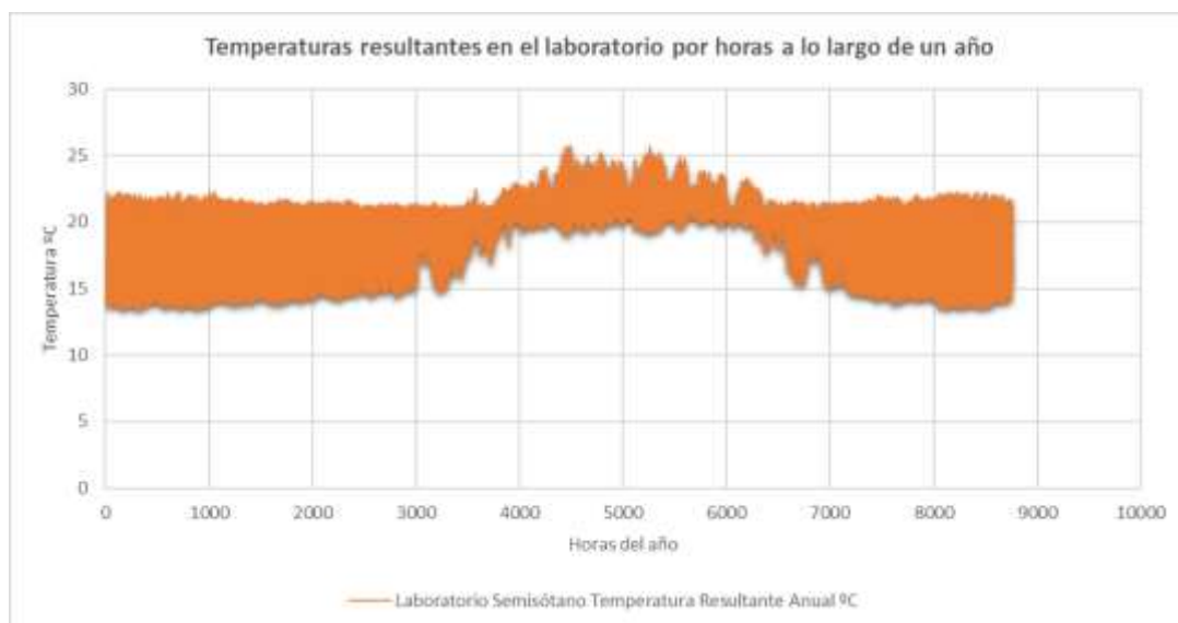
Gráfica 19: Temperaturas resultantes en laboratorios del semisótano por horas a lo largo de un año
