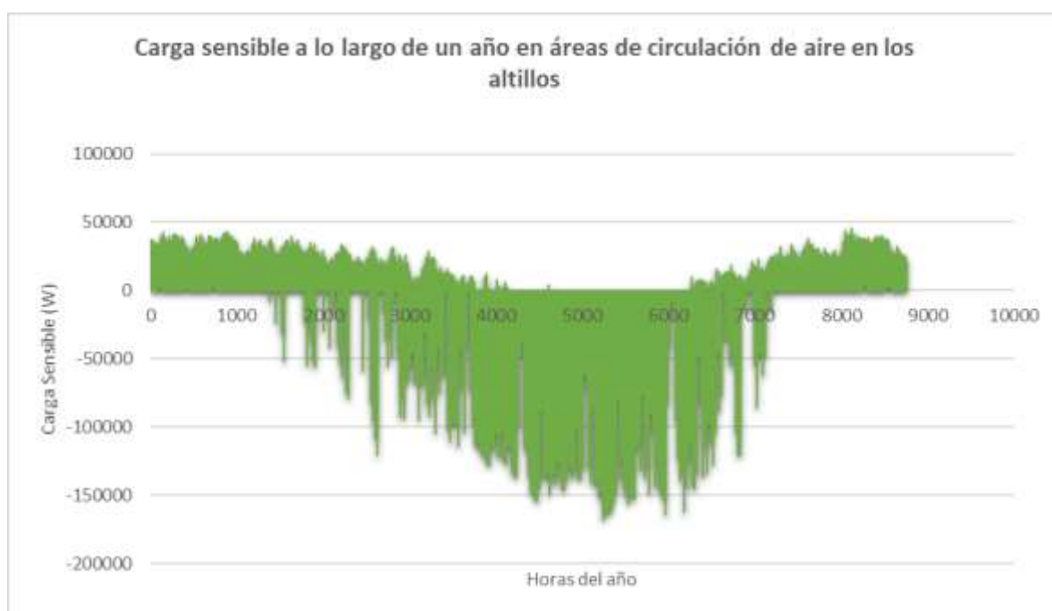
Gráfica 56: Carga sensible en las áreas de circulación de aire en los altillos
