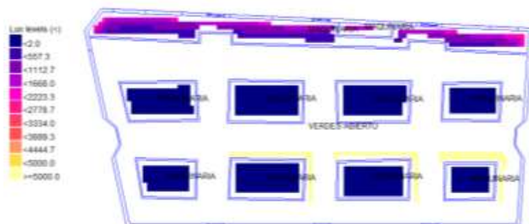
Simulación 13: Distribución de luminosidad en la planta baja reacondicionada
