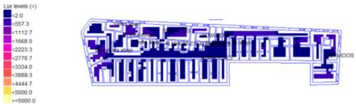
Simulación 2: Distribución de luminosidad en los altillos
