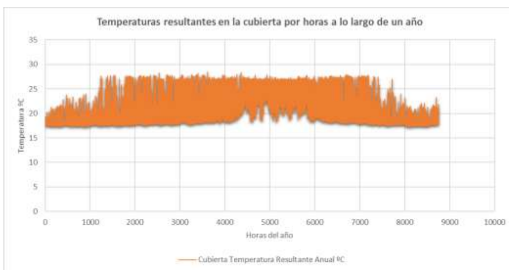
Gráfica 23: Temperaturas resultantes en el interior de la cubierta por horas a lo largo de un año
