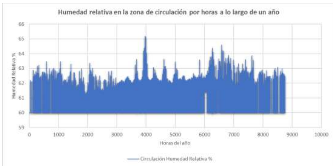
Gráfica 41: Humedad relativa en la zona de circulación de los altillos por horas a lo largo de un año
