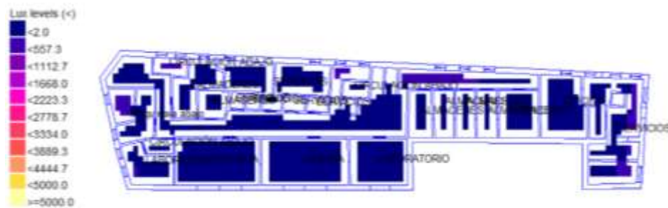
Simulación 12: Distribución de luminosidad en el semisótano reacondicionado
