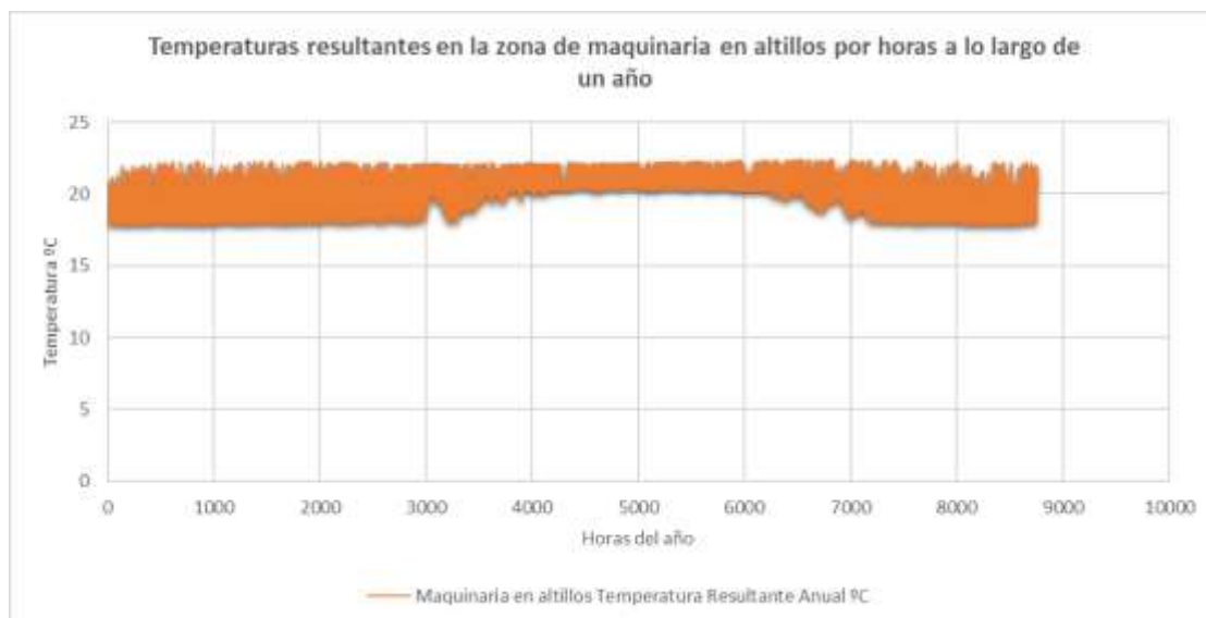
Gráfica 8: Temperaturas resultantes de la maquinaria y controles de los alttilos por horas a lo largo de un año
