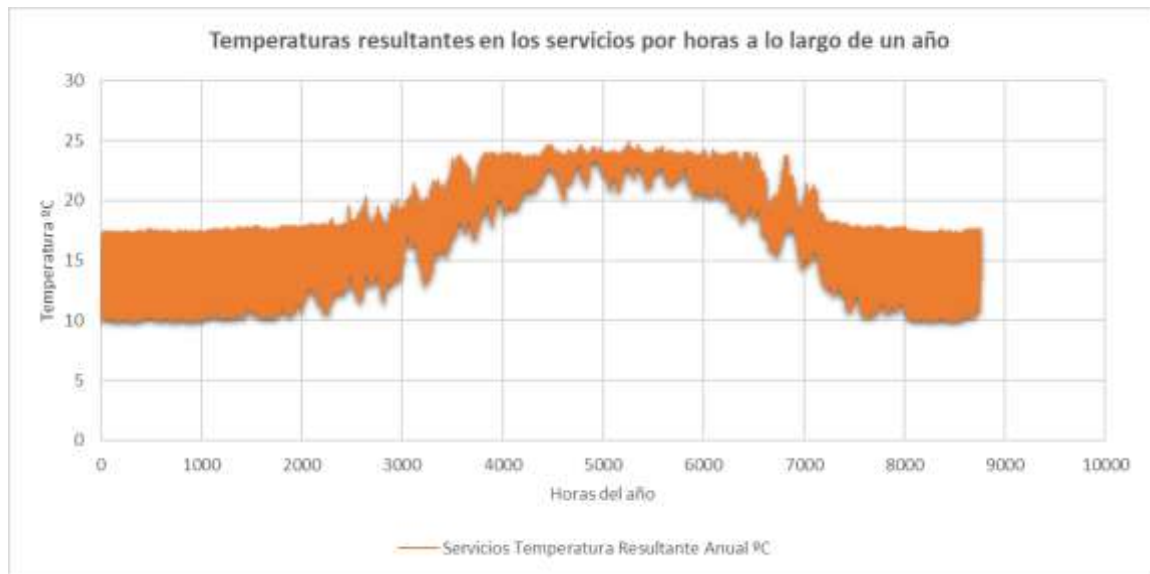
Gráfica 17: Temperaturas resultantes en los servicios del semisótano por horas a lo largo de un año
