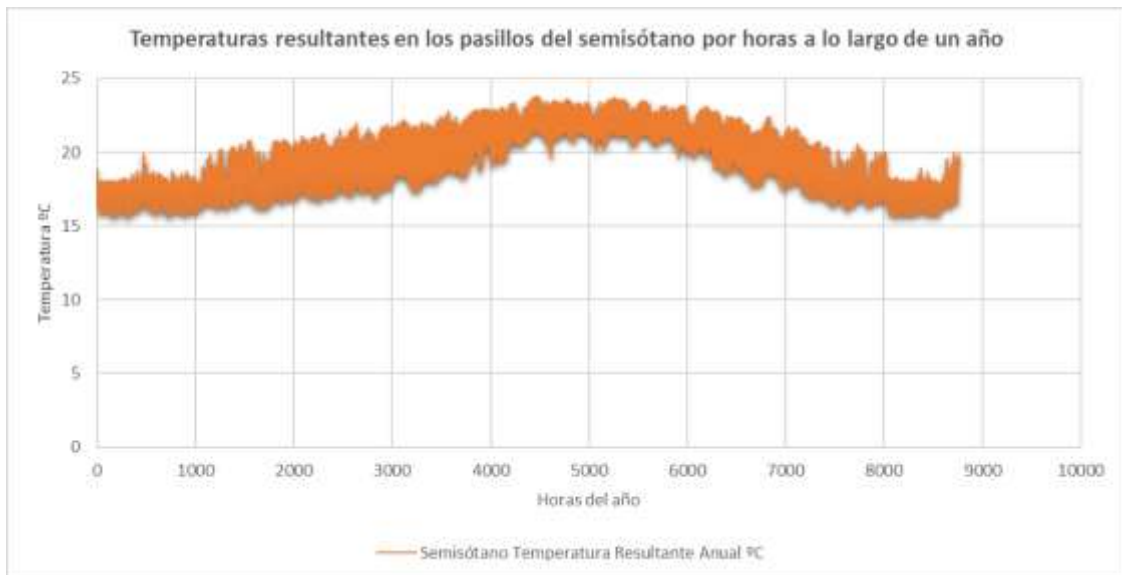
Gráfica 2: Temperaturas resultantes en los pasillos del semisótano por horas a lo largo del año
