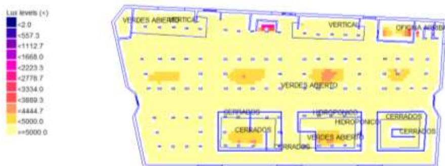
Simulación 12: Distribución de luminosidad en el semisótano reacondicionado
