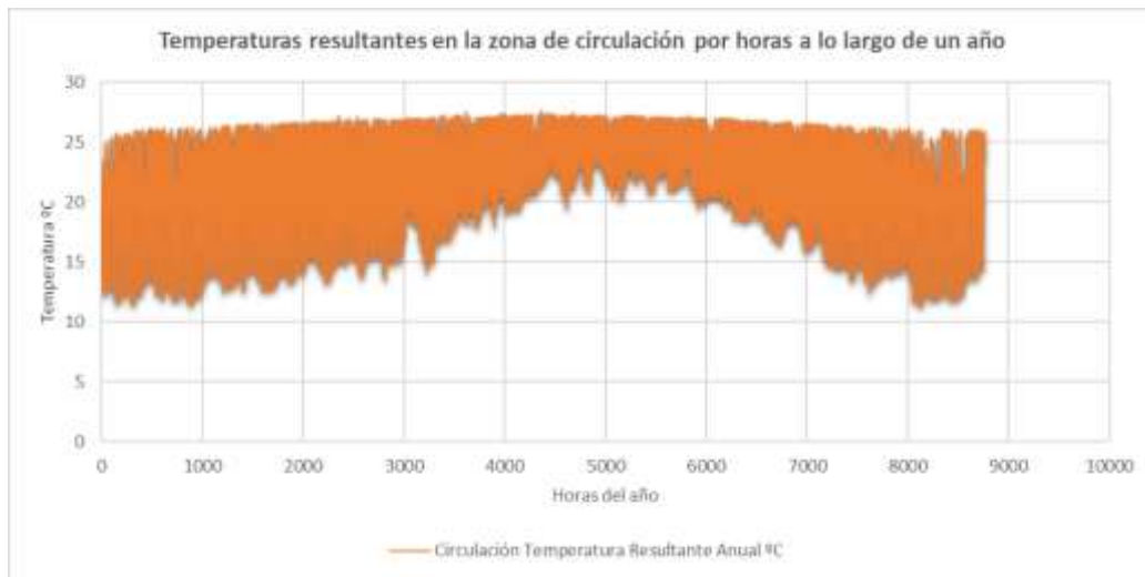
Gráfica 7: Temperaturas resultantes de la zona de circulación del público y del aire entrante por horas a lo largo de un año
