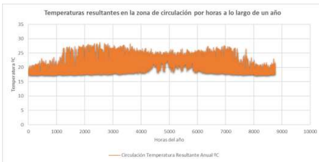
Gráfica 27: Temperaturas resultantes en áreas de circulación de aire en los altillos por horas a lo largo de un año
