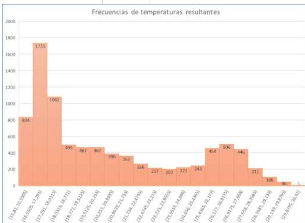
Gráfica 26: Frecuencias de temperaturas resultantes en el interior de la cubierta transparente de EFTE
