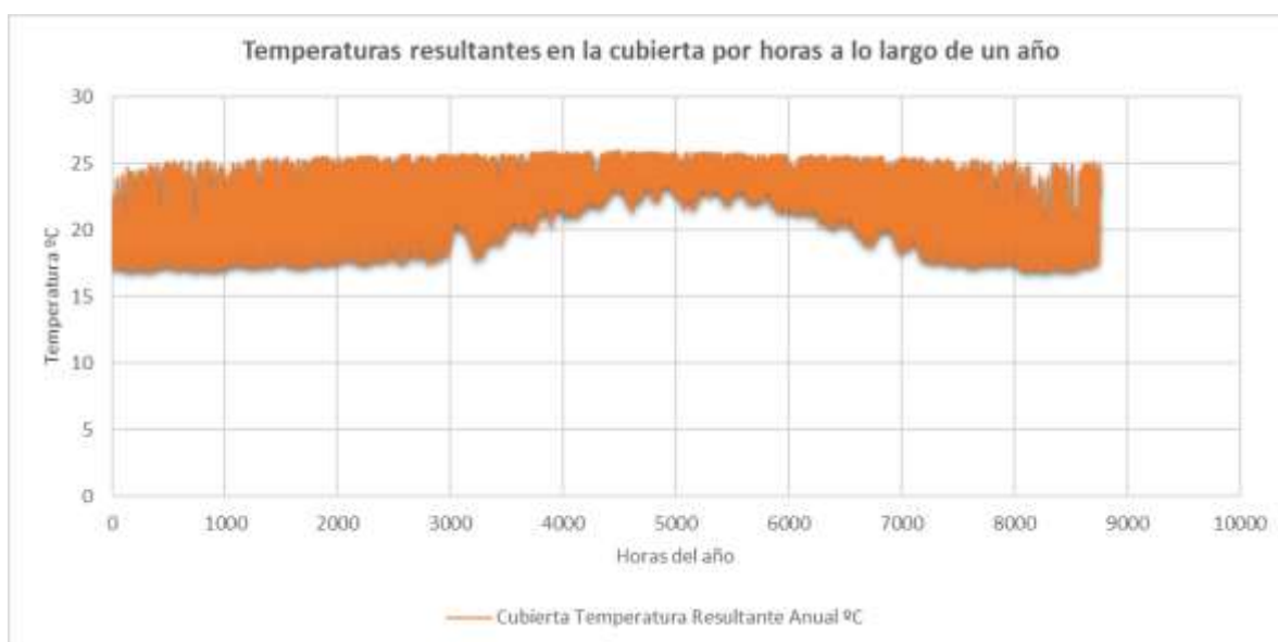
Gráfica 9: Temperaturas resultantes de la cubierta por horas a lo largo de un año
