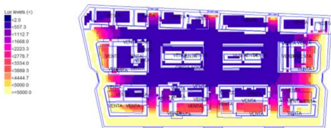
Simulación 1: Distribución de luminosidad en la planta baja
