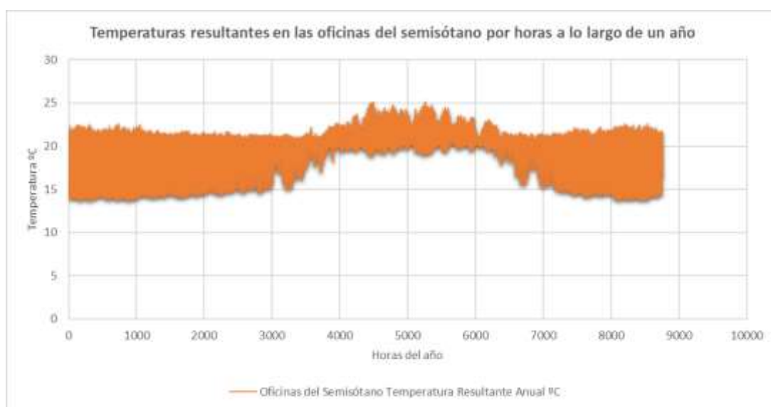
Gráfica 37: Temperaturas resultantes en las oficinas del semisótano por horas a lo largo de un año
