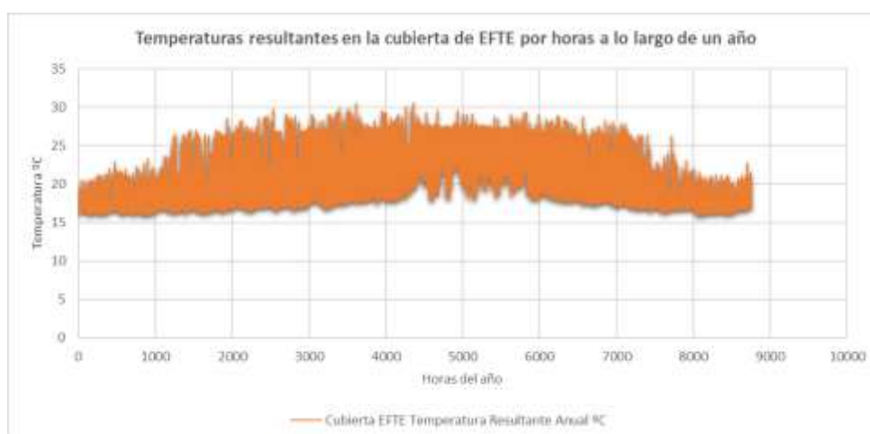
Gráfica 25: Temperaturas resultantes en el interior de la cubierta transparente de EFTE por horas a lo largo de un año
