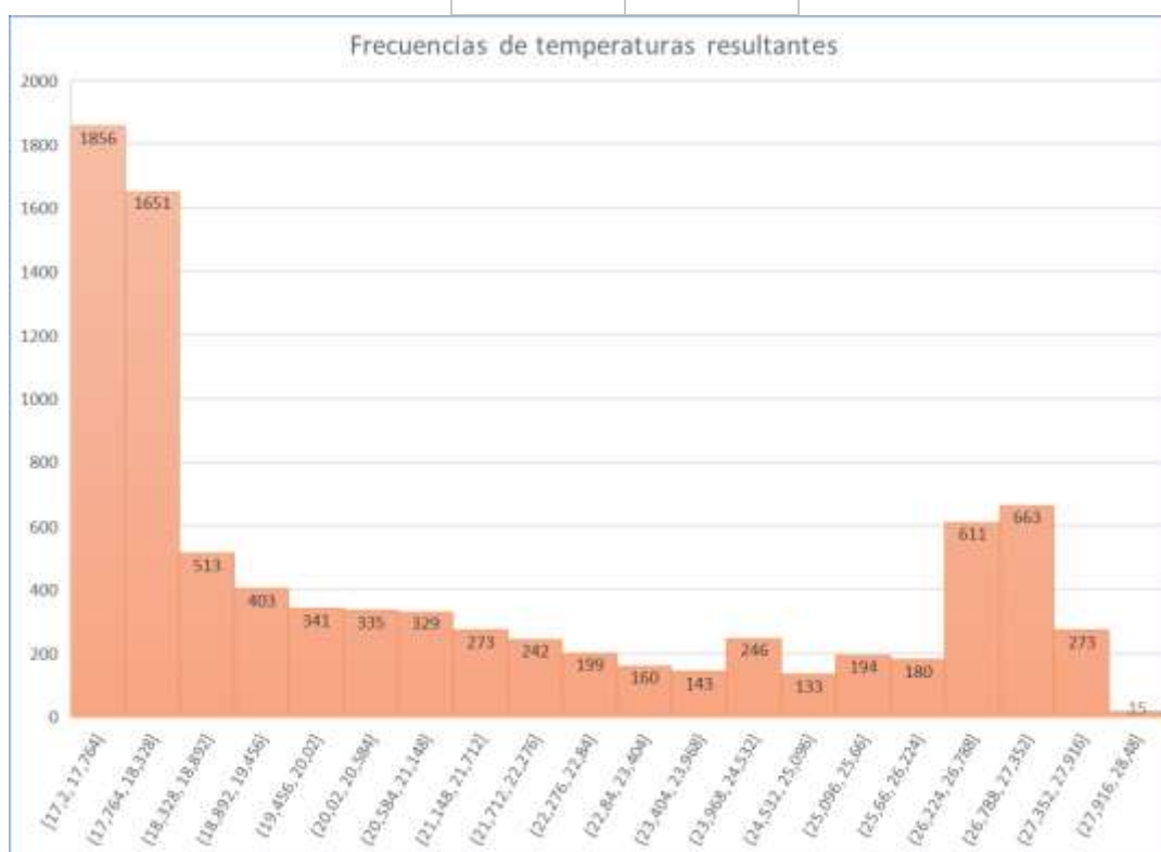
Gráfica 24: Frecuencias de temperaturas resultantes en el interior de la cubierta
