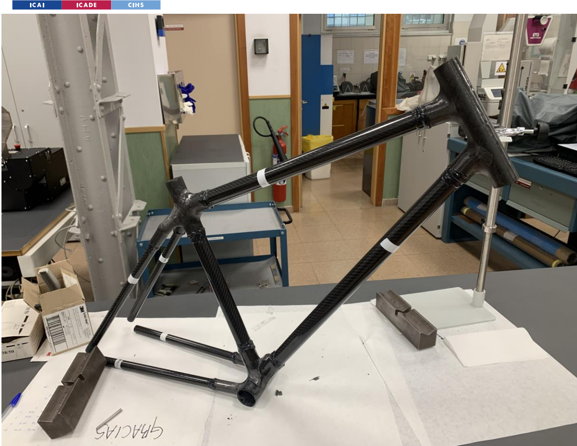
Ilustración 95: Resultado final tras la curado del adhesivo
