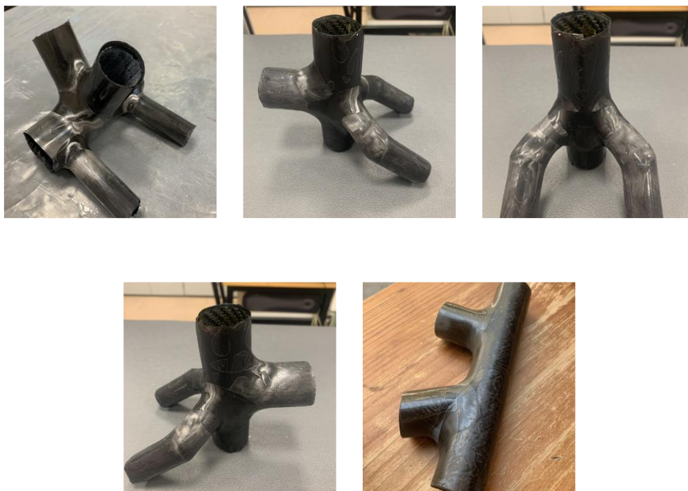
Ilustración 84: Estado de las piezas tras la limpieza
