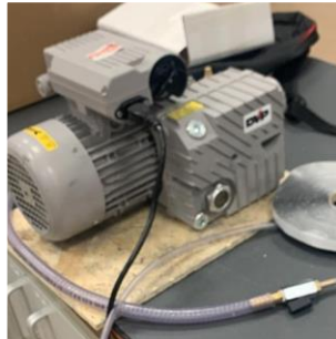
Bomba de vacío
