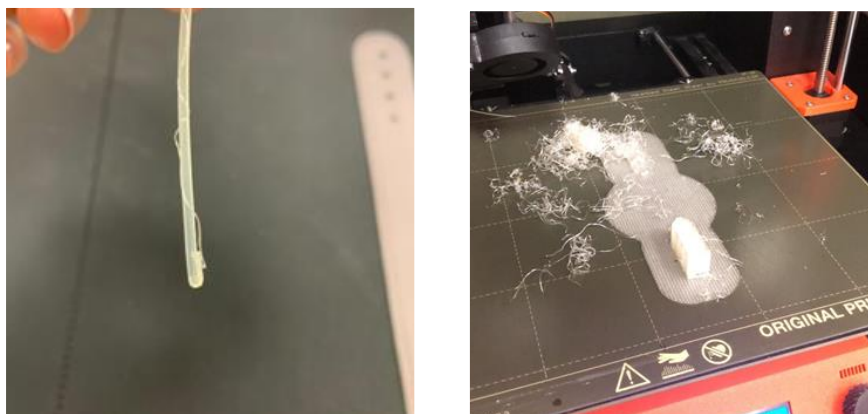
Ilustración 47: Demostración del fallo en el primer intento del modelo del conjunto sillín
