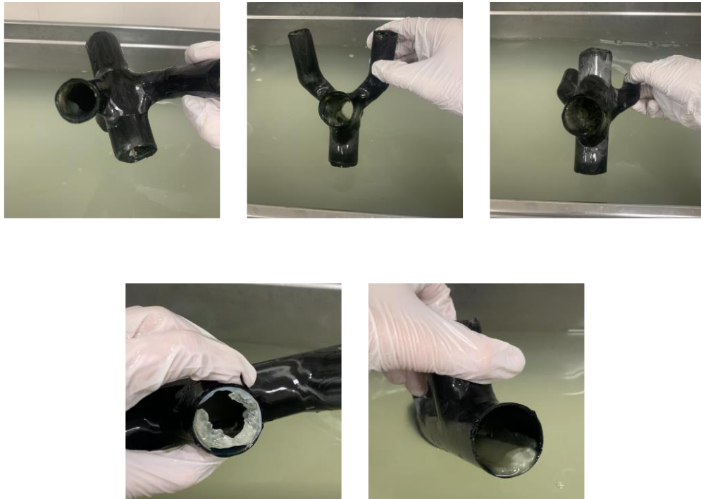
Ilustración 10: Estado de la pieza y el molde tras un periodo en la cuba ultrasónica
