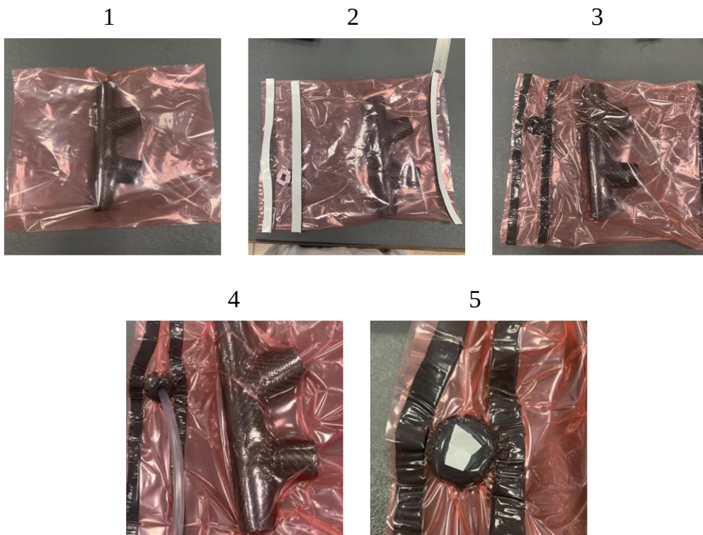
Ilustración 80: Proceso de aplicación de vacío
