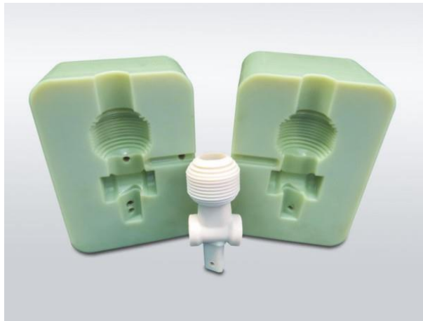
Ilustración 39: Moldes impresos en 3D con el negativo de la pieza
