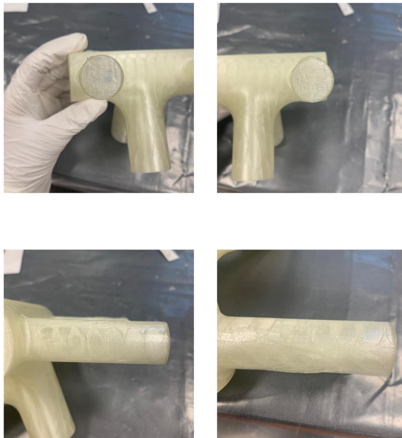
Ilustración 61: Resultados de disolver el material de soporte adherido a la pieza
