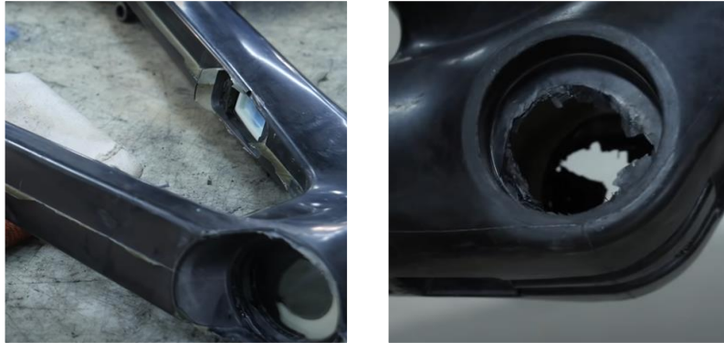
Ilustración 31: Remanentes de fibra y resina tras la curado
