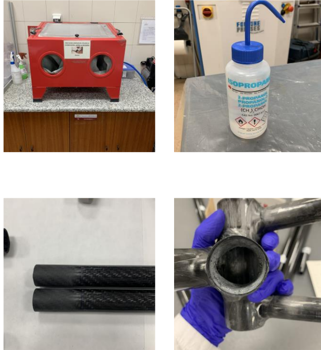
Ilustración 89: Equipos usados para lijar y limpiar las piezas y acabado final
