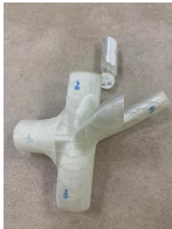
Ilustración 50: Rotura de la pieza
