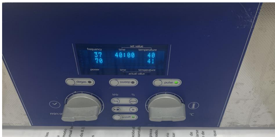
Ilustración 82: Parámetros de limpieza en la cuba ultrasónica
