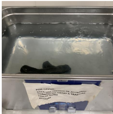
Ilustración 81: Limpiador ultrasónico usado para eliminar los moldes
