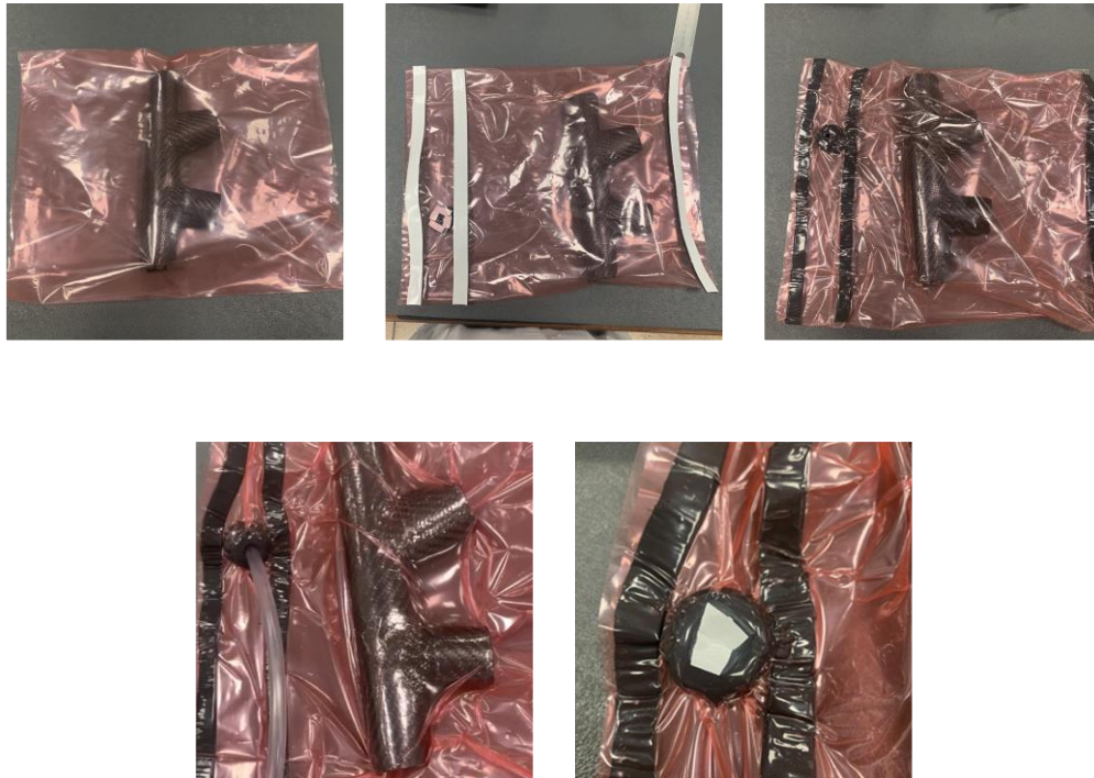
Ilustración 9: Proceso de aplicación de vacío
