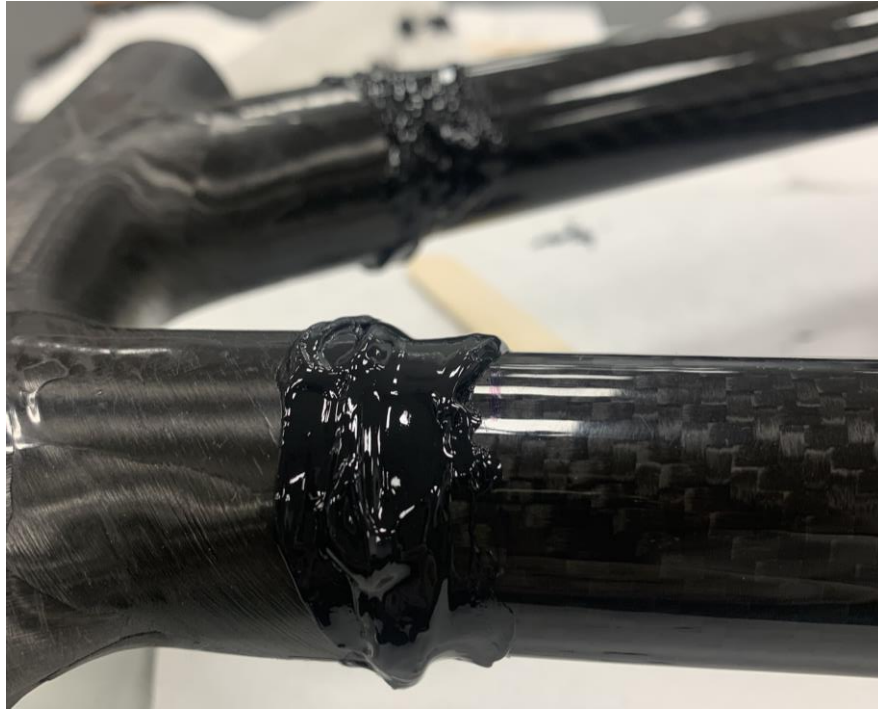
Ilustración 91: Resultado tras la aplicación del adhesivo
