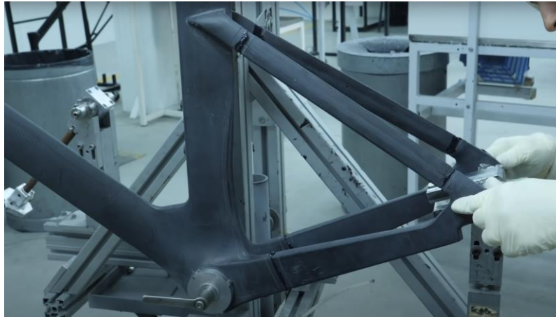
Ilustración 33: Herramienta de sujeción del cuadro durante el pegado
