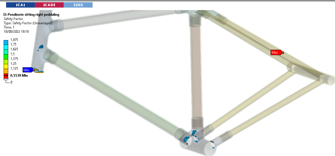
Ilustración 127: Tsai-Hill criterion con FS < 2
