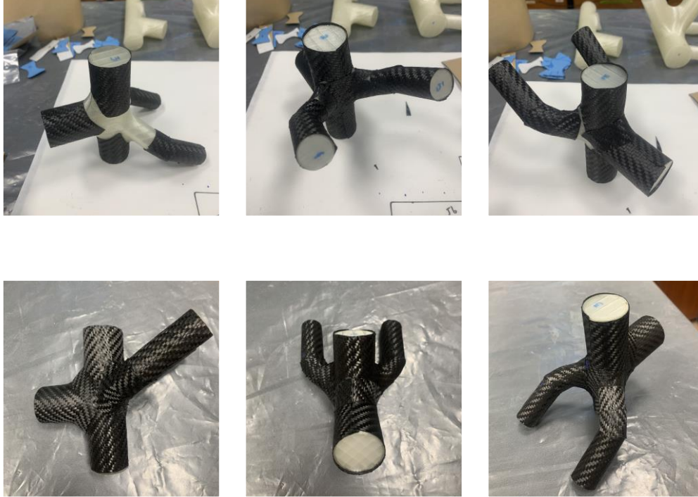
Ilustración 79: Proceso de aplicación de las capas
