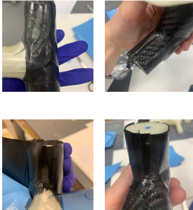
Ilustración 70: Sucesión de errores en el primer apilado
