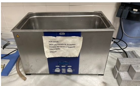
Figura 60. Equipo de ultrasonidos (izq) y estufa de vacío (der) para llevar a cabo la desgasificación
