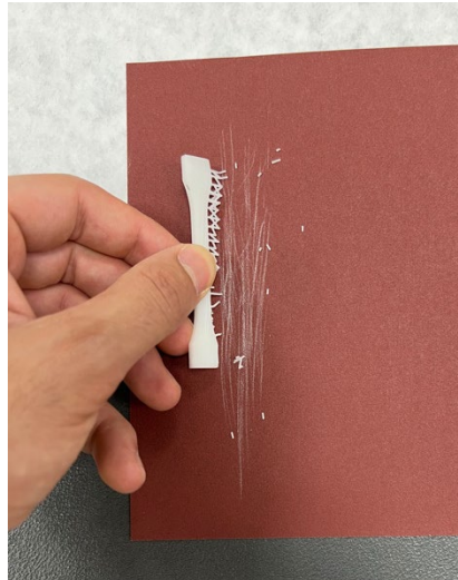
Figura 66. Lijado de una probeta de tracción
