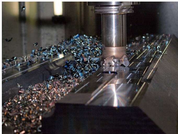
Figura 8. Arranque de viruta de un proceso de mecanizado por CNC
