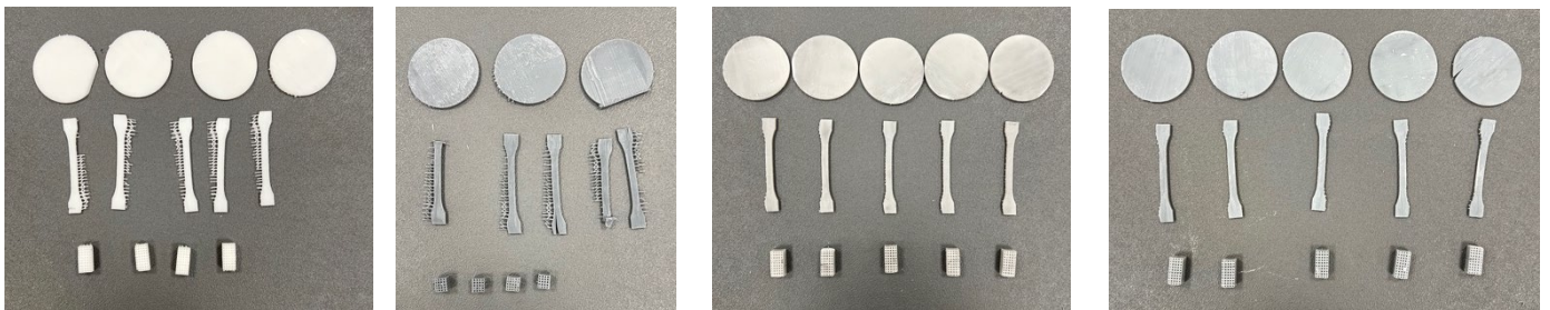
Figura 79. Conjunto de las piezas obtenidas (de izquierda a derecha): PLA, Grafeno, GO, NP-GO
