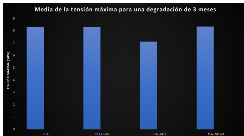
Figura 84. Representación de las medias máximas encontradas para los ensayos de tracción con 3 meses de degradación
