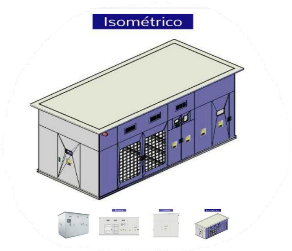
Ilustración 20: Celda media tensión (Fuente: ITESA 2022)
