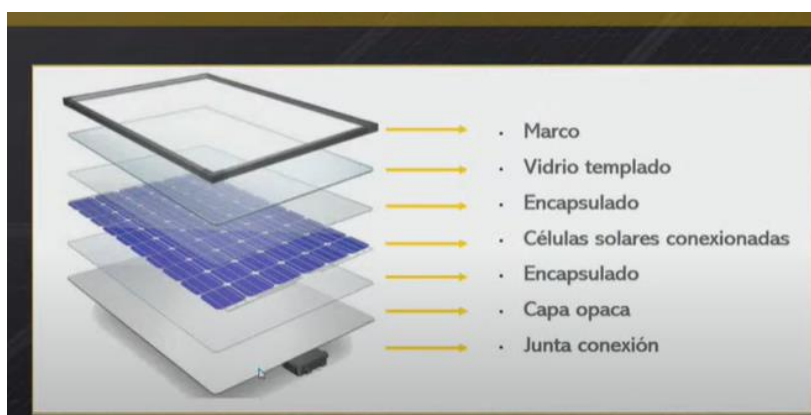
Ilustración 14: Parte de un módulo solar.
