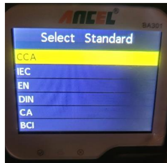
Ilustración 69: Menú norma de medida BA301.
