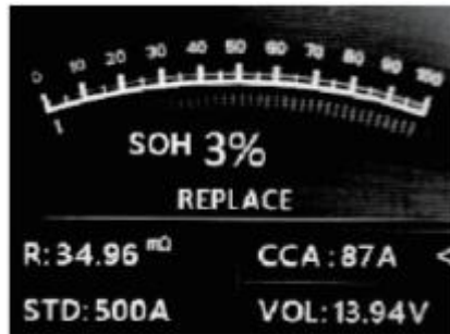
Ilustración 73: Resultado de medida 3 BA301.
