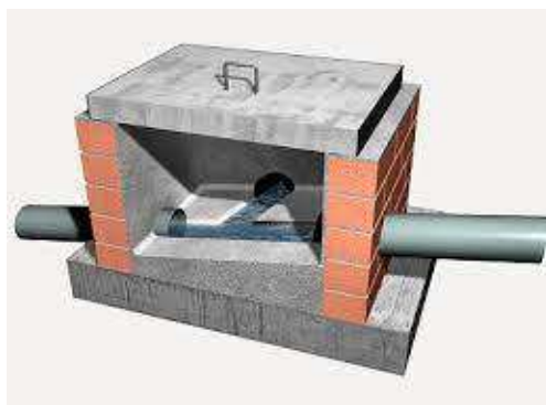
Ilustración 19: Esquema de las arquetas a construir.
