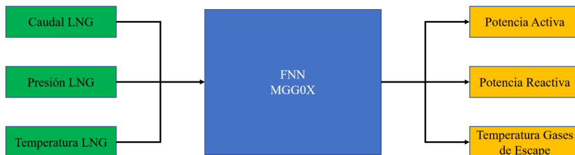
Figura 32. Estructura de los modelos de los generadores.
