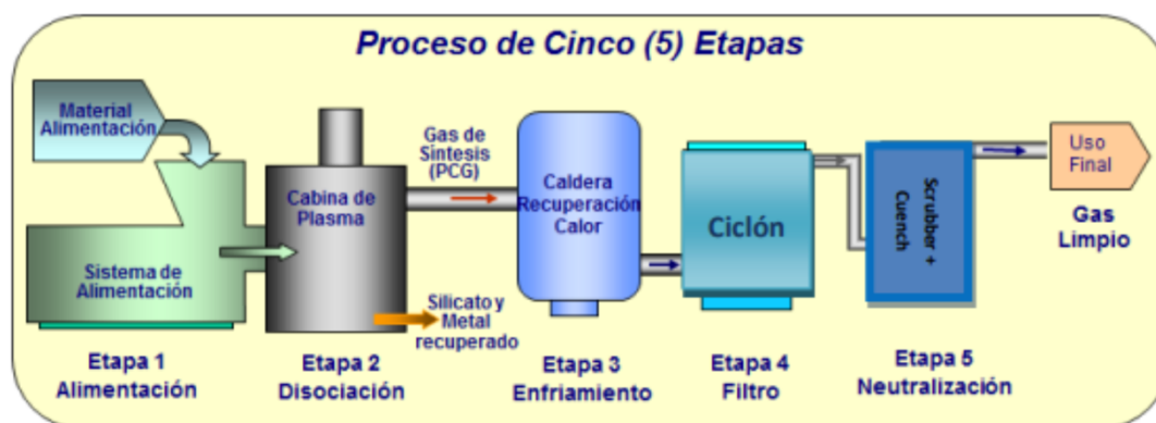
Ilustración 8. Etapas en el proceso de Gasificación por Plasma. Fuente: TFG Almudena Valenciano
