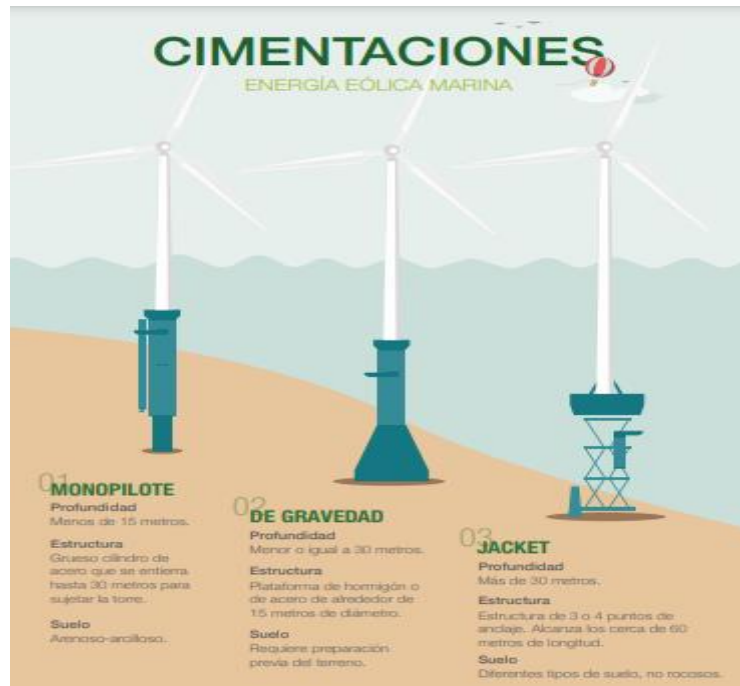
Figura 28 Diferentes tipos de cimentaciones para aerogeneradores marinos. [9]
