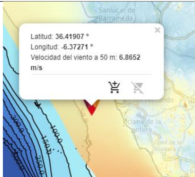
Figura 14 Captura del mapa eólico ibérico del IDEA [2] en el que se marca el punto escogido para el emplazamiento del parque
