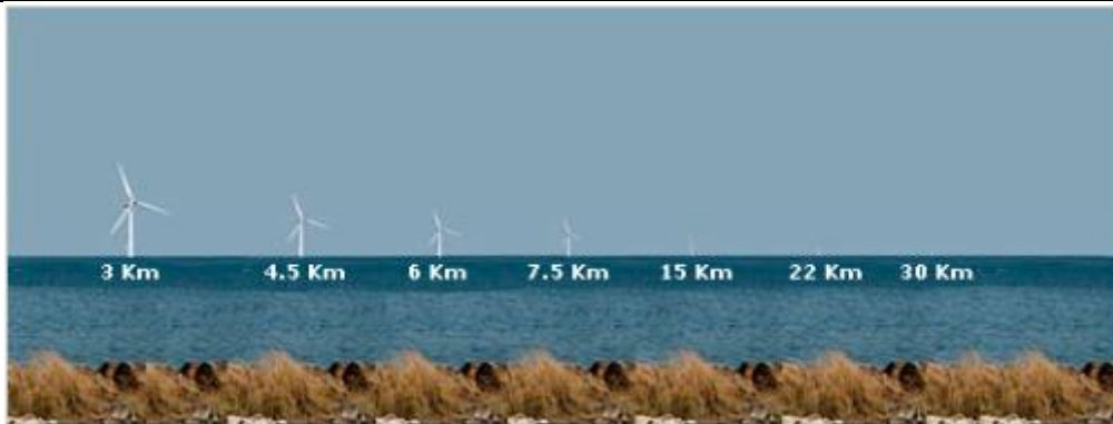
Figura 13. Impacto visual de aerogeneradores offshore en función de la distancia a la costa [16]
