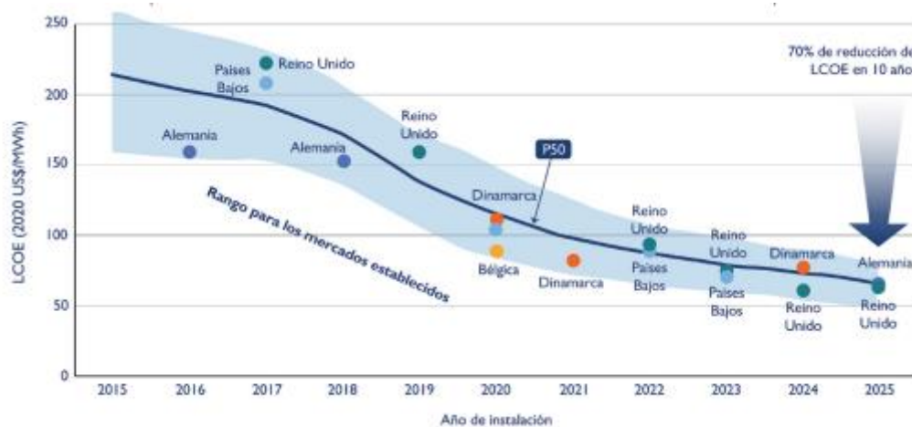
Figura 5. Reducción del LCOE de la eólica offshore. [28]
