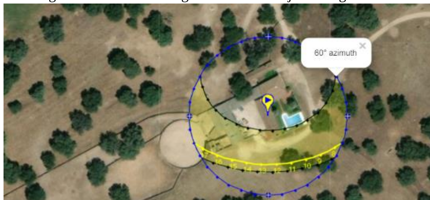
Figura 5.8: Azimut del agua derecha del tejado del guadarnés.
