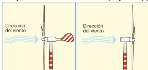
Figura 6.7: Aerogenerador de eje horizontal a barlovento (izquierda) y a sotavento (derecha).
