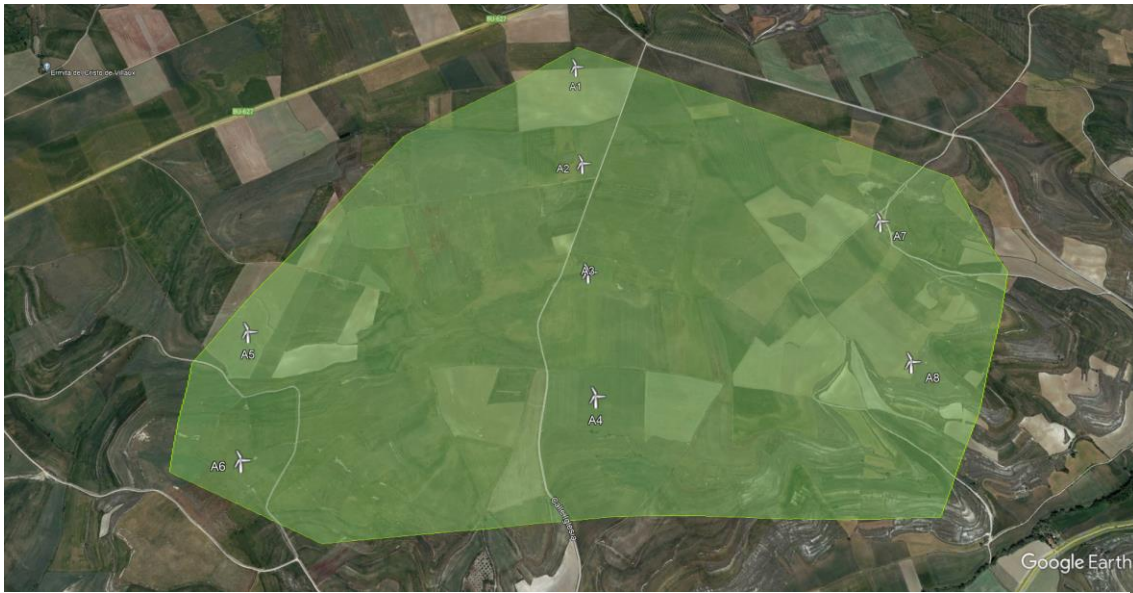
Figura 4. Disposición de los aerogeneradores en la dirección predominante del viento. -Fuente: Google Earth Pro
