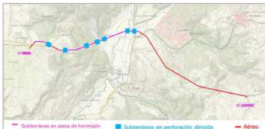
Ilustración 3. Croquizado de la traza de la instalación.
