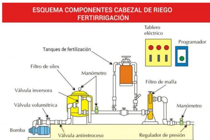
Figura 12: Esquema instalación de bombas (Fuente: Prakor, 2023)
