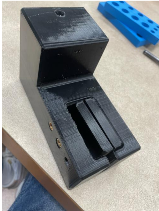
Figura 26. Prototipo 2 utillaje para ensayo de Arcan con mordazas
