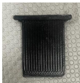
Figura 48. Prototipo para centrado de la probeta para utillaje para ensayo de Iosipescu
