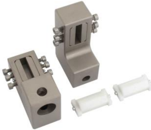
Ilustración I. Referencia de diseño para utillaje para ensayo de Arcan (Universal Grip Co.)
