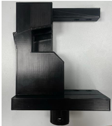
Figura 44. Cuerpo izquierdo del prototipo del utillaje para ensayo de Iosipescu
