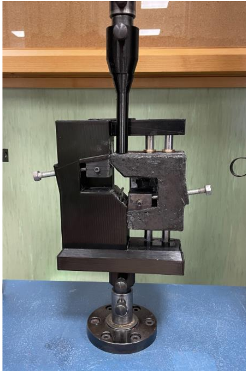
Figura 51. Montaje en máquina de ensayos del utillaje para ensayo de Iosipescu
