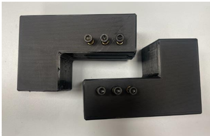
Figura 28. Prototipo final del utillaje para ensayo de Arcan
