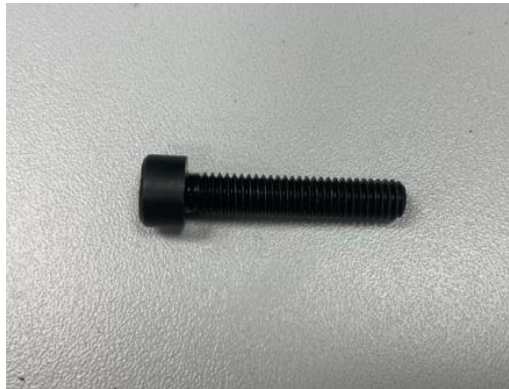
Figura 27. Tornillo M6 x30 cabeza allen empleado para el utillaje para ensayo de Arcan
