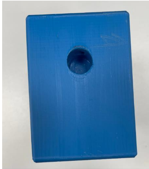
Figura 23. Primer prototipo utillaje para ensayo de Arcan
