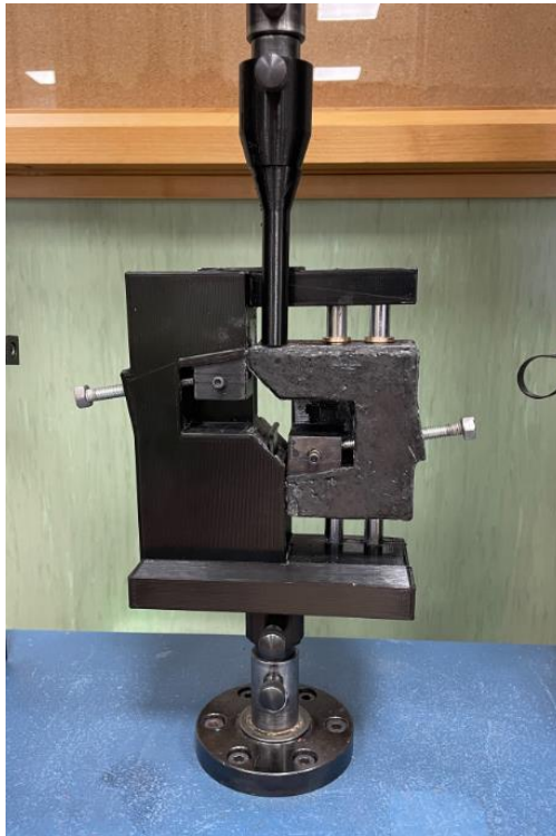
Ilustración VII. Montaje en máquina de ensayos del utillaje para ensayo de Iosipescu
