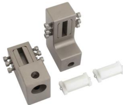
Figura 10. Referencia de diseño para utillaje para ensayo de Arcan (Universal Grip Co.)
