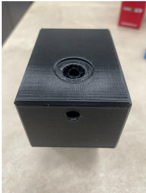
Figura 25. Prototipo 2 del utillaje para el ensayo de Arcan
