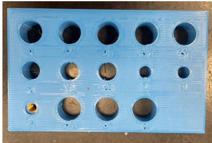
Figura 17. Prueba de inserto roscado M6
