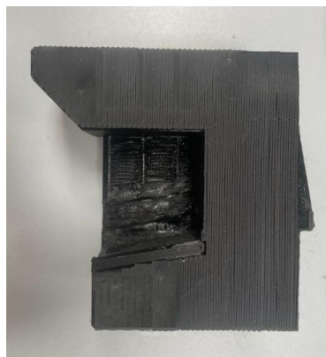
Figura 45. Cuerpo derecho del prototipo del utillaje para ensayo de Iosipescu
