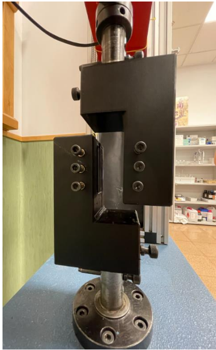
Ilustración VI. Montaje en máquina de ensayos del utillaje para ensayo de Arcan
