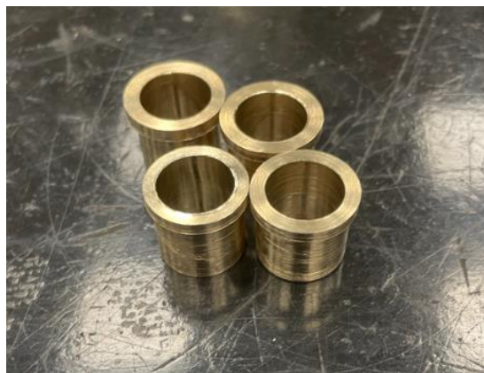
Figura 42. Casquillos fabricados en torno para utillaje para ensayo de Iosipescu
