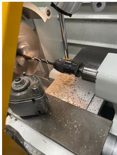
Figura 41. Operación de taladrado en torno para los casquillos
