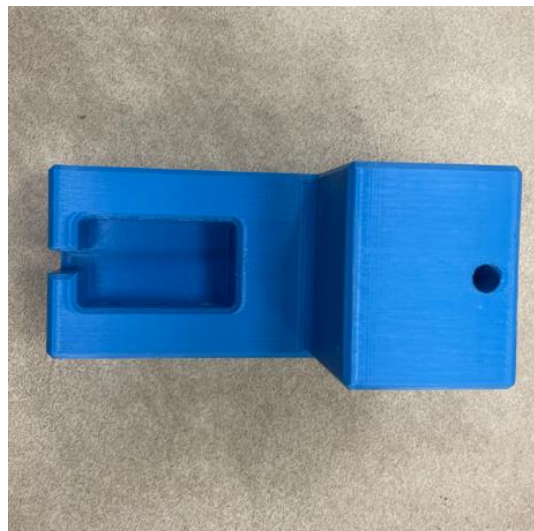
Figura 24. Primer prototipo utillaje para ensayo de Arcan
