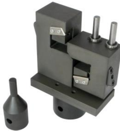
Ilustración III. Referencia de diseño para utillaje para ensayo de Iosipescu (Universal Grip Co.)
