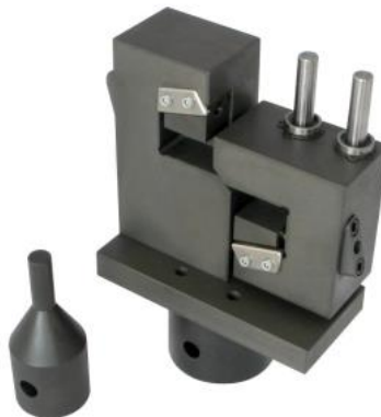
Figura 30. Referencia de diseño para utillaje de ensayo de Iosipescu (Universal Grip Co.)
