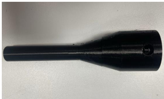
Figura 46. Prototipo del punzón para el utillaje para ensayo de Iosipescu
