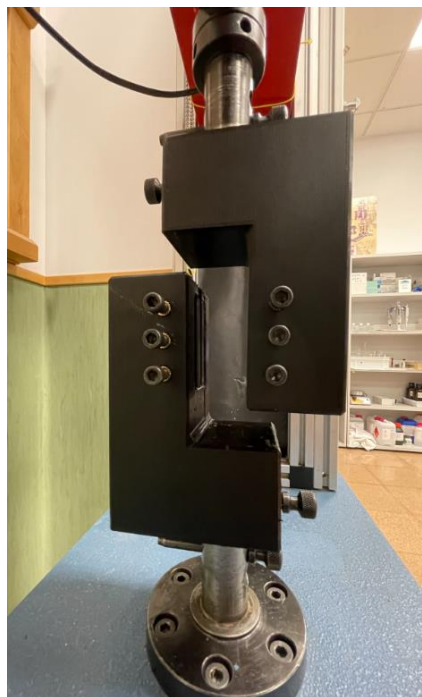
Figura 50. Montaje en máquina de ensayos del utillaje para ensayo de Arcan
