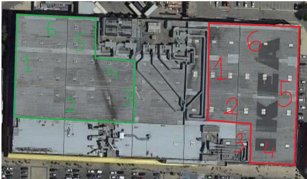
Figura 14.1: Medida de la cubierta del proyecto fotovoltaico de IKEA en San Sebastián de los Reyes.
