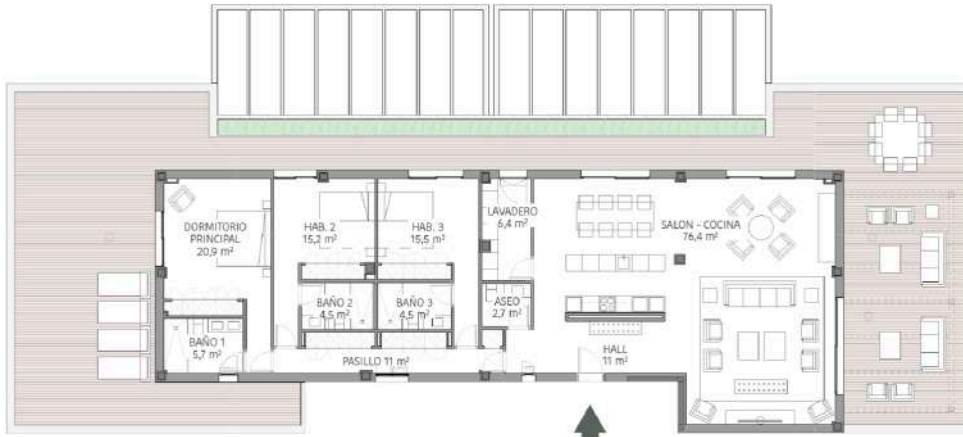
Ilustración 13. Distribución interna de la vivienda Roof Garden [10].
