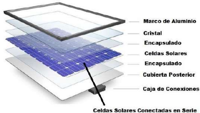
Ilustración 37. Láminas que conforman un módulo fotovoltaico [16].
