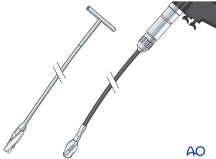
Figura 4.9: La herramienta para fresar el canal medular es la siguiente. Tiene un extensor flexible para poder pasar por dentro del canal[4].
