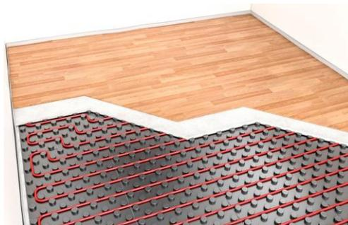
*Ilustración 12: Calefacción por suelo radiante*
